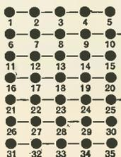
Le piastre possono essere collegate ad incastro per formare circuiti di qualunque dimensione. I componenti vengono semplicemente inseriti nei contatti, senza saldatura alcuna, ed estratti con altrettanta semplicità quando occorre.
