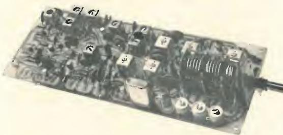
Ricevitore per la banda 28-30 Mc/s (a richiesta 26-28 Mc/s o 26,8-27,4 Mc/s) progettato per l'uso in unione con convertitori 144-146 Mc/s. Impiega 3 Mosfet autoprotetti, 2 Fet, 6 transistori al silicio, 5 diodi, 1 zener.
