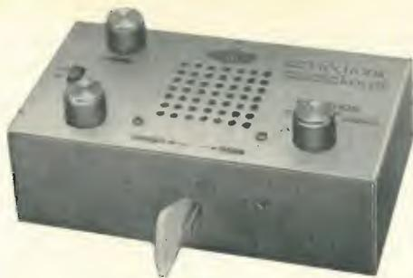
Questo tasto elettronico è stato progettato per soddisfare le richieste dei radioamatori che si dedicano alla CW. Esso consente di ottenere manipolazioni la cui velocità è regolabile mediante un doppio comando.
