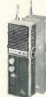
Frequenza: Riceve e trasmette su 6 canali CB - Semiconduttori: 14 transistors, 1 circuito integrato che funge da amplificatore di medie frequenze a 7 stadi e rivelatore in BF, 1 termistor, 1 transistor per il circuito antirumore « squelch » - Potenza di ingresso: 5 W - Sensibilità di ricezione: 1 µV a 10 dB - Alimentazione: 12 V (8 pile stilo 1,5 V). Presa adattatore alimentazione esterna.
