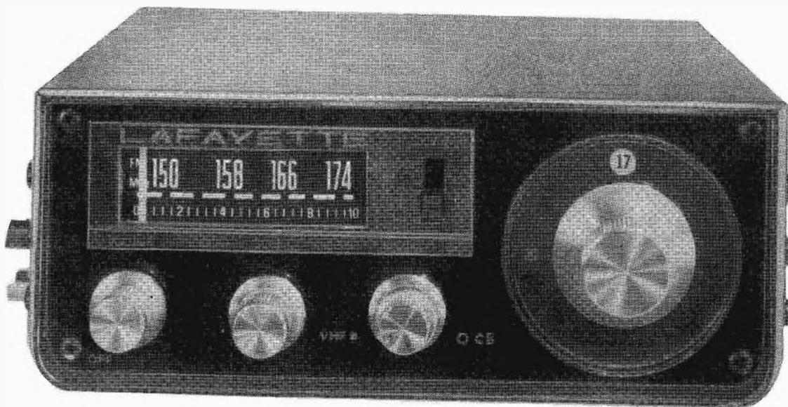
Esiste comunque anche la possibilità di ascoltare la frequenza radiometrica dei 144 MHz (due metri) dove operano i radioamatori (OM) con una semplice modifica, o scorrimento di banda che dir si voglia. Questo è il LAFAYETTE TELSAT 150.
