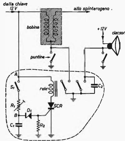
A questo punto lo zener D<sub>1</sub> inizia a condurre così il gate dello SCR viene polarizzato causando il passaggio di stato da interdizione a conduzione del semiconduttore. Otteniamo così la chiusura dei contatti del relè e quindi gli effetti poc'anzi descritti.
