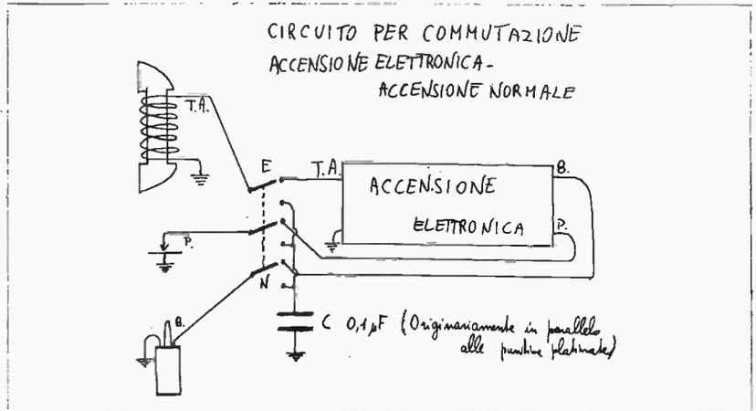
Se il commutatore è dotato di zero centrale può anche servirci da antifurto, forse un po' spartano...
