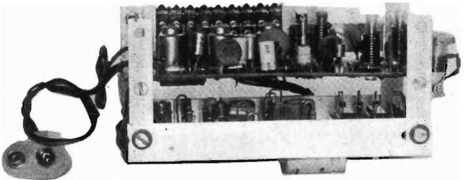
Il relé scatta quando  $E_{12,1}$ =negativa,  $E_{12,2}$ =positiva. La operazione effettuata è quindi un AND, anche se un po' insolito, vista la polarità dei segnali. C, introduce un certo ritardo nel rilascio del relé per evitare che esso vibri, dato che il segnale di ingresso è a impulsi.
