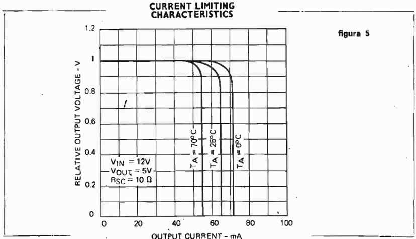
Come si può notare dalla figura, con l'uscita in corto ( $V = 0$ ) e  $R_{sc} = 10 \Omega$ , la corrente a  $25^\circ C$  è di 65 mA.  $V_{sc}$  è quindi 0,65 V, che assumeremo d'ora in poi come dato per progettare  $R_{sc}$  quando ci interessi ottenere la limitazione per valori diversi di corrente (?).
