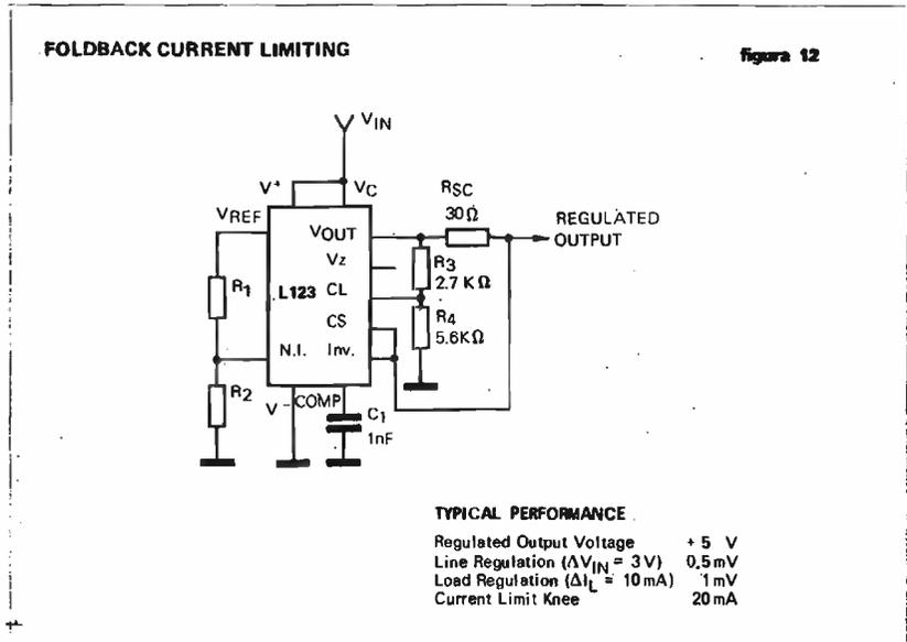
Le formule per il dimensionamento dei valori resistivi in funzione della tensione d'uscita e delle due correnti, di ginocchio  $I_K$  e di cortocircuito  $I_{SC}$  possono essere facilmente ricavate dalle seguenti relazioni:
