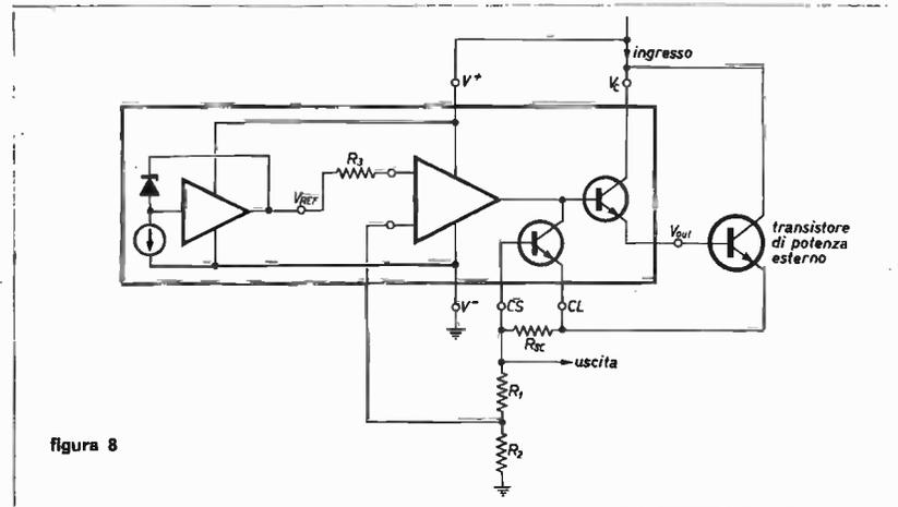
Il transistor esterno viene collegato a quello integrato in connessione Darlington: lo stadio ha guadagno in tensione unitario, e il guadagno in corrente è pari al prodotto dei guadagni in corrente dei transistori impiegati. Supponiamo di impiegare un transistor regolatore esterno con un guadagno in corrente di 50. La corrente
