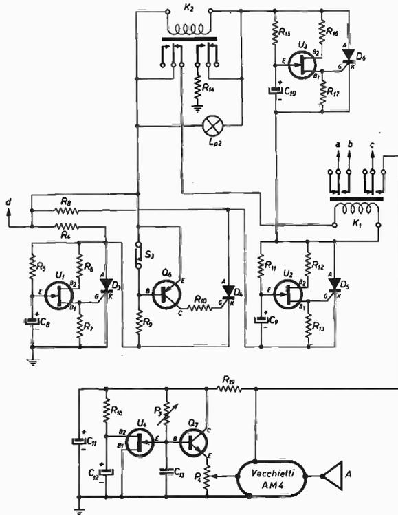
capi viene ad essere presente una tensione che, inviata al gate di  $D_3$ , permette al SCR di alimentare il circuito di guardia e di cortocircuitare l'oscillatore impedendogli altri impulsi di tensione. Preciso che  $R_1$  serve soprattutto ad assicurare la corrente di mantenimento al diodo SCR affinché rimanga nello stato di conduzione fino a quando viene tolta la tensione di alimentazione.
