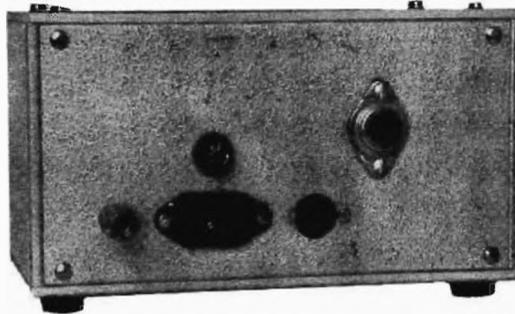
La posizione «flottante» (massa non collegata nè a positivo nè a negativo) può essere utile, ad esempio, per l'alimentazione di circuiti integrati, quando necessiti disporre due identici alimentatori in serie fra loro, oppure quando la tensione di uscita venga suddivisa, mediante un partitore composto da due resistori e due diodi zener, e sia allora desiderabile avere la massa metallica collegata al centro dei diodi:
