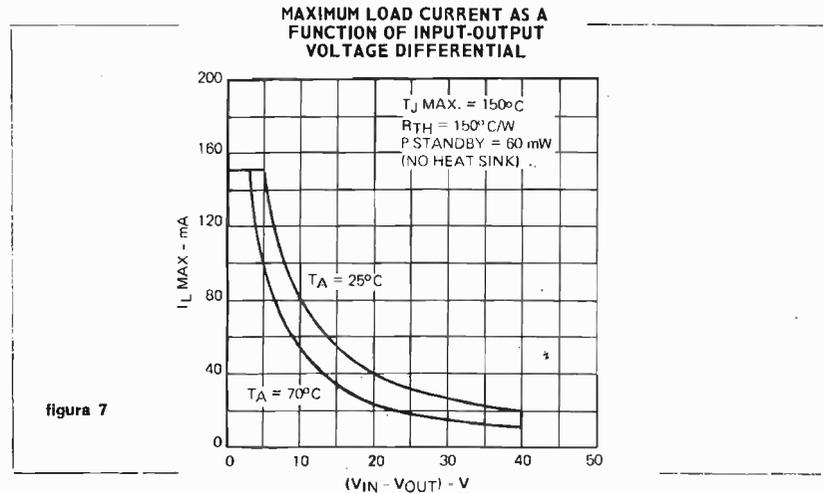
Come si vede i valori di corrente di uscita ottenibili usando solo l'integrato sono piuttosto modesti, e insufficienti per molte applicazioni. Si possono ottenere valori di corrente maggiori modificando il circuito con l'aggiunta di un transistor esterno di potenza amplificatore di corrente. Il circuito è questo:
