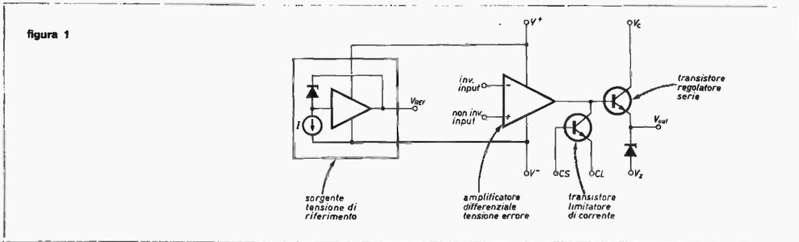
Come si può notare, l'integrato contiene sostanzialmente quattro blocchi funzionali: una sorgente di tensione di riferimento estremamente stabile; un amplificatore differenziale della tensione errore; un transistore regolatore serie e un transistore limitatore di corrente (1).
