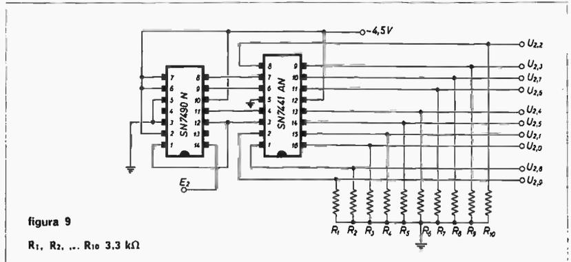
Si collega  $E_2$  a  $U_1$ . Si fa oscillare il multivibratore e si avrà su ciascuna delle dieci uscite un impulso di 2.5 ms come da figura 10, la quale, purtroppo, non è in scala con la precedente figura 8. Le dieci uscite portano due pedini, di cui il secondo indica quale cifra decimale corrisponde a quel piedino.
