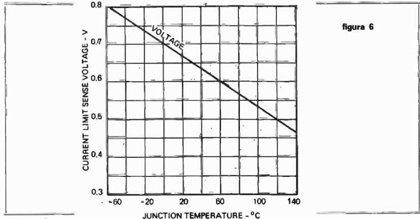
Per il progetto è comunque corretto nella maggioranza dei casi riferirsi al valore che  $V_{sc}$  ha a  $25^\circ C$  di temperatura della giunzione, ossia 0,65 V.
