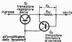
In questo modo, a partire da un certo valore di corrente in poi, la coppia  $Q_1$ - $Q_2$  si comporta come un generatore di corrente costante e, mano a mano che la resistenza di carico diminuisce, la caduta di tensione, e quindi anche la dissipazione, si localizzano tutte ai capi di  $Q_1$ . Ecco infatti come si presenta la caratteristica di limitazione risultante:
