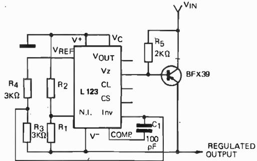
E' da notare che, quando sia possibile fare a meno della protezione contro il cortocircuito, ciò che può essere ottenuto anche nei circuiti-base già visti ponendo  $R_{SC} = 0$  e lasciando non collegati i terminali CS e CL, si ottiene una migliore regolazione al variare del carico, come si può vedere dal confronto dei due diagrammi seguenti:
