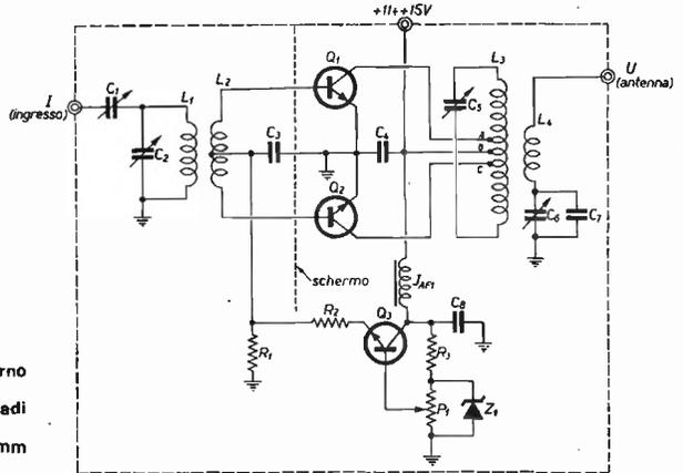
Nota importante da tener presente è quella di fare un montaggio simmetrico per i collegamenti che riguardano i due BD117, trattandosi di un push-pull per di più in radio frequenza.
