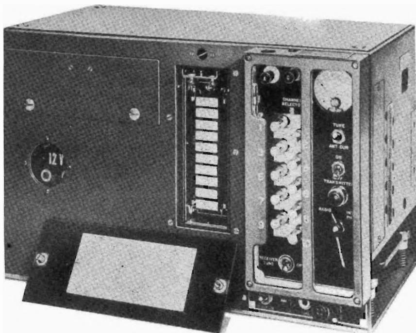
Frequenza coperta da 20 a 28 Mc suddivisa in 80 canali corredato di: n. 8 valvole termoioniche. - Relè di antenna: doppio contatto in ceramica. - Strumento di misura corredato di termocoppia R.F. - Dimensione del BC: cm 40 x 30 x 15. Peso circa Kg 22.
