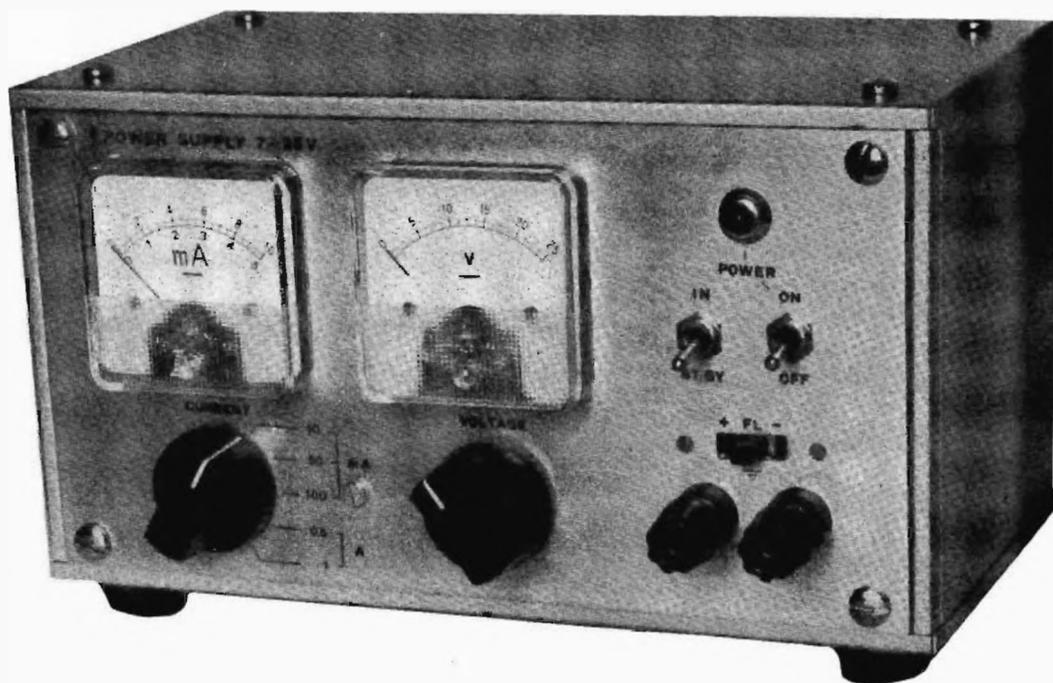
Poiché in condizioni normali è conveniente far lavorare l'alimentatore sufficientemente lontano dal ginocchio ove la caratteristica tensione-corrente comincia a incurvarsi per effetto del circuito di limitazione, e la resistenza interna dell'alimentatore passa da un valore molto prossimo a zero ad un valore elevatissimo, i fondo scala dello strumento non coincidono con i valori di corrente limite, ma sono tenuti più bassi secondo un rapporto 1 : 1,5 (tranne che nella prima portata).
