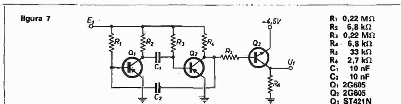
E' un multivibratore seguito da un invertitore di fase. Quando l'ingresso  $E_1$  è alto (negativo) il multivibratore oscilla e il segnale a onde quasi perfettamente quadre viene ulteriormente squadrato e potenziato da  $Q_3$ . Se invece  $E_1$  è basso l'oscillatore si ferma e la uscita  $U_1$  permane alta. La frequenza del segnale si aggira sui 400 Hz. La forma d'onda è visibile in figura 8.
