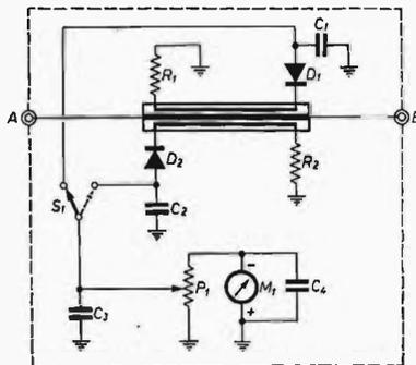
Infine aggiungo che se la padella è spenta... pardon... intendevo dire che se tutto il baracco è spento, l'antenna rimane collegata all'uscita e tutto funziona in modo normale, cioè senza amplificatore e il ROSmetro darà l'indicazione della potenza d'uscita del solo trasmettitore. I collegamenti RF vanno eseguiti con cavetto coassiale di impedenza uguale a quello dell'antenna già esistente (si spera!).
