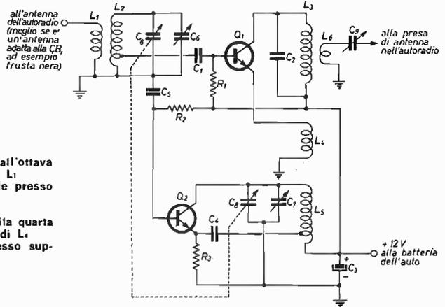
I supporti di L<sub>1</sub>, L<sub>2</sub>, L<sub>4</sub>, L<sub>5</sub>, sono del diametro di 8 mm in plastica
