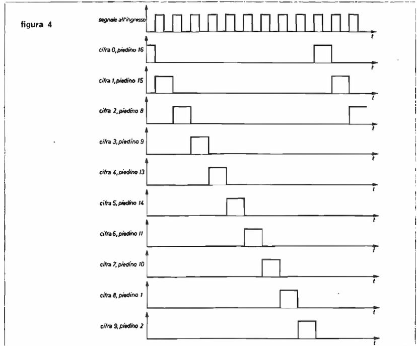
La figura 4 mostra i segnali sulle uscite del contatore in corrispondenza di un segnale di ingresso costituito da impulsi rettangolari tutti uguali; gli impulsi alle uscite hanno tutti uguale durata. Non così avviene nel caso di figura 5 ove gli impulsi di ingresso di posto 4, 5, 7 sono stati, a bella posta, allungati.
