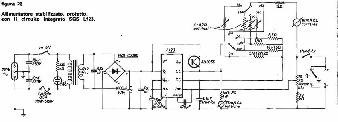
Per scavalcare il problema della realizzazione di shunt di basso e bassissimo valore, che si sarebbe presentato volendo effettuare la misura ampermetrica nel modo consueto, ho scelto la via di misurare la caduta sulla resistenza  $R_{sc}$  (tranne che nella prima portata, in cui lo strumento è disposto in serie direttamente).
