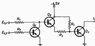
Si collega E<sub>s,1</sub> a U<sub>1</sub>, E<sub>s,2</sub> a U<sub>2,0</sub>. Sul collettore di Q<sub>1</sub> si ritrova normalmente il segnale in uscita dal formatore, tranne che in corrispondenza dell'impulso 0. In questo caso Q<sub>1</sub> satura e porta il suo collettore a massa. Q<sub>2</sub> è un emitter follower che non carica apprezzabilmente l'ingresso e pilota energicamente il finale Q<sub>3</sub>. La figura 18 riporta la forma d'onda sull'emitter di Q<sub>2</sub>.
