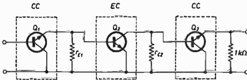
Sostituiamo ora in questo circuito ai vari transistori i loro circuiti equivalenti per piccoli segnali e alle frequenze intermedie. Lo schema diventerà quello di figura 7.
