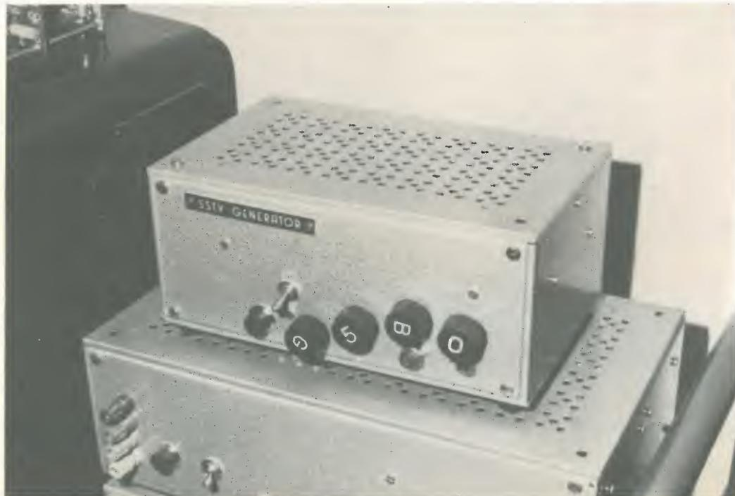
Tutte le resistenze sono da  $1/2\text{ W}$  e tutti i transistori sono degli NPN al silicio che possono essere sostituiti da altri equivalenti. Nel pannello anteriore è sufficiente porre l'interruttore di rete, il commutatore rotativo doppio a una via e sei posizioni, il potenziometro da  $5\text{ k}\Omega$  per la scala dei grigi e il potenziometro da  $500\ \Omega$  per la regolazione dell'uscita del segnale SSTV.
