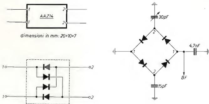
Forse qualche parola sul montaggio non guasta. Il termine « modulatore bilanciato » suggerisce un'idea di simmetria anche nel montaggio dei vari componenti. Insisto sulla bontà dei componenti, il condensatore fisso da 15 pF deve essere di mica argentata mentre quello variabile da 30 pF non può essere del tipo a pressione (vale qui lo stesso ragionamento fatto per gli oscillatori a cristallo).
