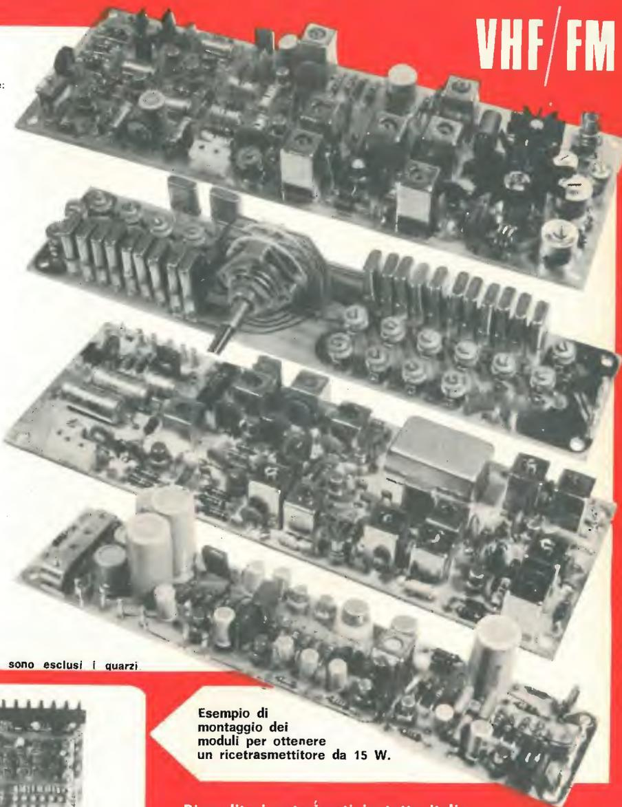
Esempio di montaggio dei moduli per ottenere un ricetrasmittitore da 15 W.
