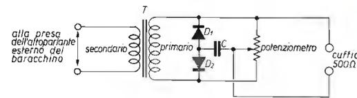
T trasformatore di uscita da 1 W, primario 600 Ω, secondario 8 Ω
