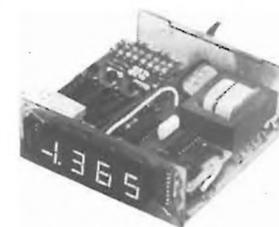
Voltmetro digitale a 3 1/2 cifre. Portata 1,999 V fs. Usa display FND500. Impedenza d'ingresso 1000 MΩ. Precisione 0,2% ±1 digit. Usa i nuovi IC Siliconix LD110 e LD111. Indicazione automatica di polarità e Overrange. Completo di alimentaz. 220 V ca. L. 59.500
