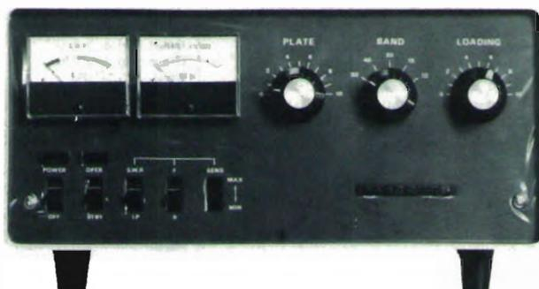
Il modello FL 2277 contiene due valvole tipo 572B (operanti in classe B) raffreddate ad aria forzata soffiata da due ventilatori potenti ma estremamente silenziosi. Il lineare può essere pilotato da qualunque TX che abbia un paio di contatti supplementari di relay; comunque si affianca al meglio sia funzionalmente che esteticamente con gli apparati FT 277 B e TS 288, formando con il ricetrasmittitore una combinazione di grande potenza.
