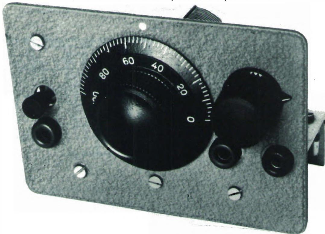
*Ho usato un pannello con telaio e condensatore variabile già montati, di cui disponevo. Ho fatto il circuito stampato, fissato al telaio, e ho ottenuto così un insieme compatto e molto rigido: questa è sempre una buona condizione nei montaggi VHF.*
