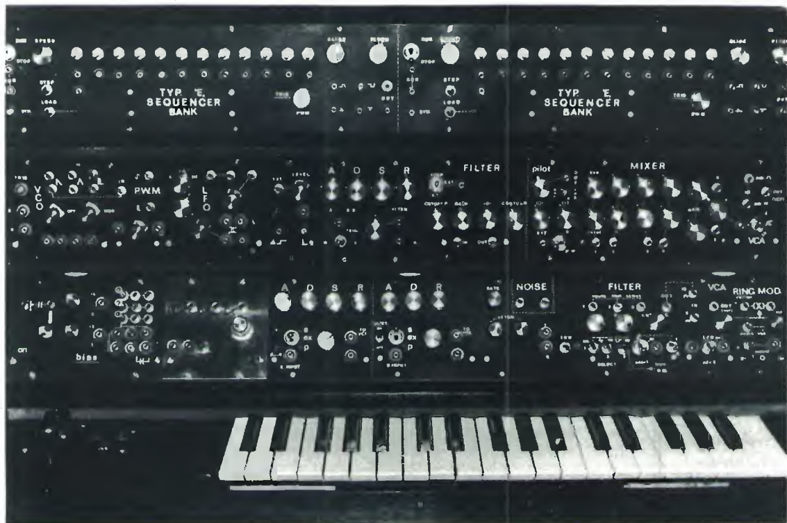
Ancora una veduta dell'« ex-mio » sint: si noti dove sono i VCO, con i « modificatori » (seconda fila) P.W.M. per modulare la quadra, e il gruppo LFO.
