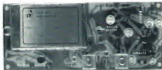
Eccitatore - Trasmettitore FM T 5252 Frequenza di lavoro 88 - 110 MHz Deviazione 100 KHz Dimensioni mm. 75 x 180 x 28
