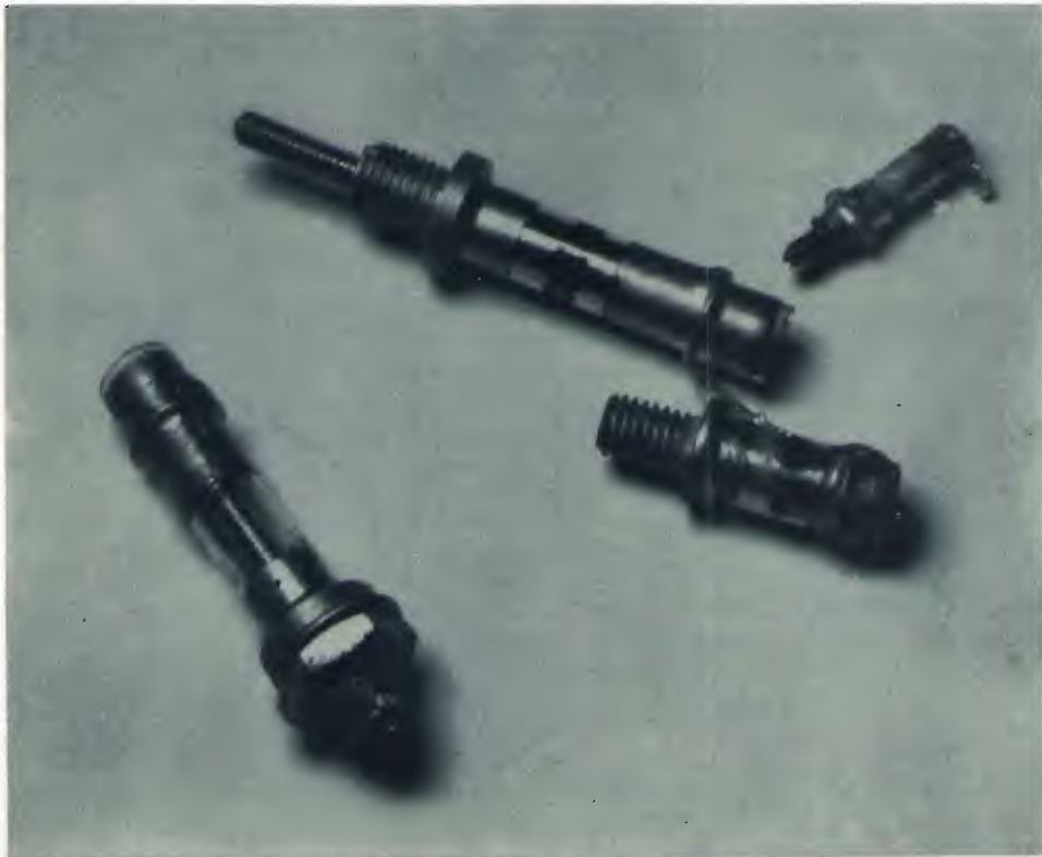
Compensatori di elevate caratteristiche trovati NUOVI (!) sulle bancarelle, spicca, nella sua bruttura, un volgare ceramico per tuner TV.
