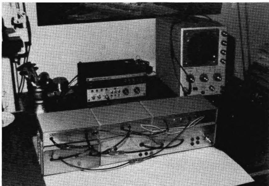
**Preamplificatore d'antenna** — Necessario, oltre che per incrementare i segnali che verrebbero successivamente attenuati dalla linea di discesa, anche per adattare l'impedenza di uscita all'impedenza caratteristica del cavo coassiale. E' costituito da due transistori per altissima frequenza (BFY90).
