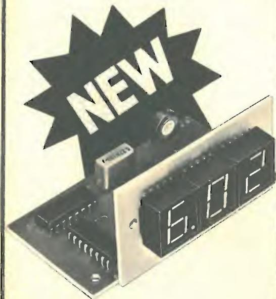
La tecnica digitale, che offre elevata precisione e chiarezza di lettura, è alla base di questo eccellente voltmetro a tre cifre per tensioni continue dal minimo di 1 mV al massimo di 999 V.
