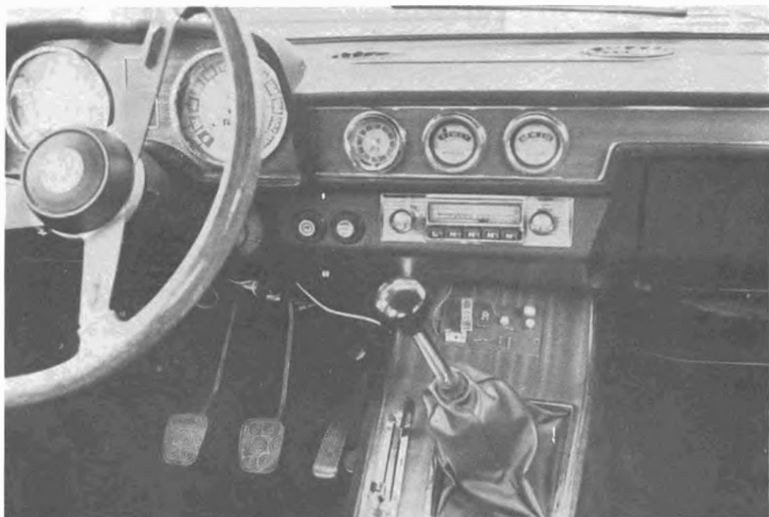
Montaggio su autovettura. Notare come la fotocellula non riceve l'illuminazione direttamente dall'esterno dell'abitacolo.
