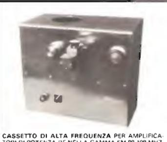
**CASSETTO DI ALTA FREQUENZA PER AMPLIFICATORI DI POTENZA RF NELLA GAMMA FM 88-108 MHz COSTRUZIONE PROFESSIONALE IN OTTONE ARGENTATO CON ISOLAMENTI IN PTFE. COMPLETO DI WATTMETRO E ROSMETRO. VALVOLA IMPIEGANTE 3CX1500A7 8877.**
