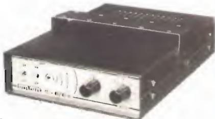
L'applicazione di questo transverter in serie tra un qualsiasi Trasmettitore CB (Baracchino) e l'antenna 40/45 metri, come un normale amplificatore lineare, permette al CB di entrare nella nuova frequenza dei 40/45 metri.
