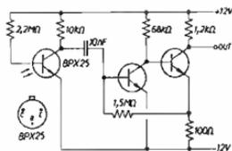
Opportuno, per distanze relativamente grandi, l'uso di lenti ottiche. R in funzione del tipo di led impiegato; sensibilità, per una intensità luminosa di 1 lux, sul BPX25, si ottengono 400 mV in uscita; banda passante,  $20 \div 4.000$  Hz a 3 dB. Portata raggiunta durante le prove, lente sul led e ricevitore con raccogliore pseudoparabolico (colapasta!) circa 300 m, di notte.
