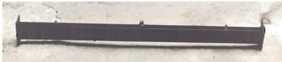
Attenzione! Saldare ermeticamente (con ottime saldature, non fredde!) altrimenti si ha cattivo funzionamento della cavità.
