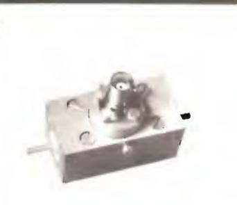
**WATTMETRO PASSANTE PER AMPLIFICATORI RF DI PICCOLA POTENZA COMPLETO DI TESTINA DI LETTURA**
