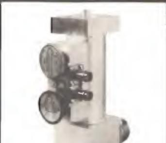
**WATTMETRO RF PASSANTE CON DOPPIA TESTINA PER LA LETTURA SIMULTANEA DELLA POTENZA DIRETTA E RIFLESSA, CON PRELIMINARE PER LA PROTEZIONE DI R.O.S. ELEVATO.**
