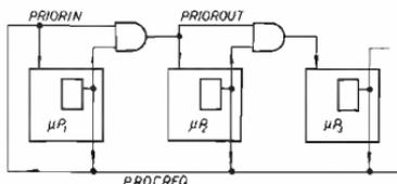
La linea PRIORIN attraversa ogni microprocessore e viene trasmessa solo se il  $\mu p$  non ha bisogno del bus; la linea PROCREQ va a 1 quando il  $\mu p$  fa richiesta del bus.
