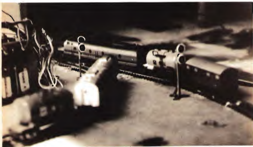
Un treno transita su uno degli scambi mentre l'altro è fermo al segnale su cui si evidenzia acceso il led rosso in alto. Sullo sfondo, il gruppo dei relay.
