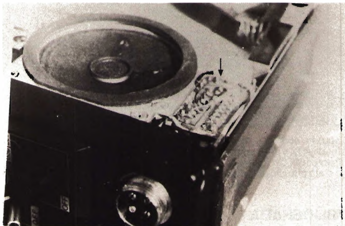
Circuito alloggiato all'interno dell'IC202, lato altoparlante.
