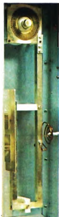
Gruppo R.F. in ottone argentato con circuito di uscita «capacitivo» per trasferire tutta la potenza sull'antenna.
