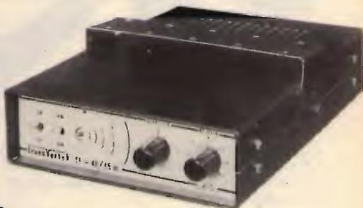
L'applicazione di questo transverter in serie tra un qualsiasi Trasmettitore CB (Baracchino) e l'antenna 40/45 metri, come un normale amplificatore lineare, permette al CB di entrare nella nuova frequenza dei 40/45 metri.
