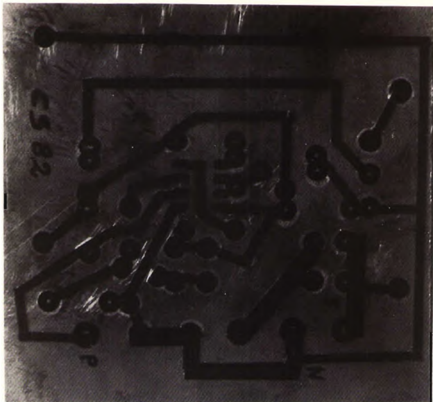
Circuito stampato prima dell'incisione (si noti l'uso dei trasferibili e le successive correzioni)
