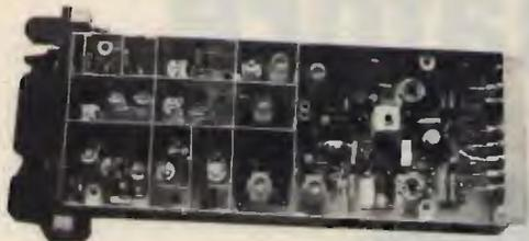
Quarzabile da 130÷170 MHz - Quarzo 12-13 MHz - Potenza di uscita 10 Watts - Alimentazione 12 Volts - Ingresso bassa frequenza - Microfono piezo o dinamico - Regolazione deviazione di frequenza.
