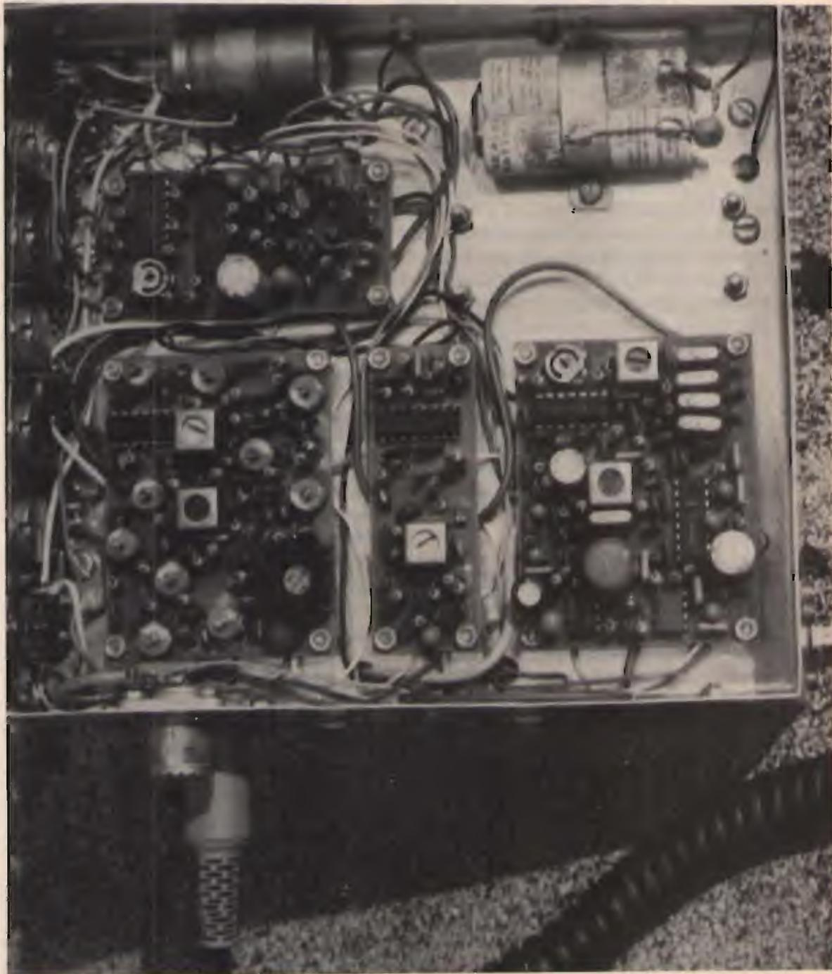
spire di  $L_{18}$ . Dopo ogni intervento su  $L_{18}$  è però necessario anche rifare le saldature per allentare le tensioni meccaniche nel filo della bobina per ridurre la "microfonicità" del VCO!
