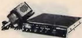
Ricetrasmittitore veicolare o base, CB AM-FM-SSB, omologato PT, 34 canali da 26.875 + 27.265, pot. 4 W, 27 MHz, alim. 13,8 c.c.
