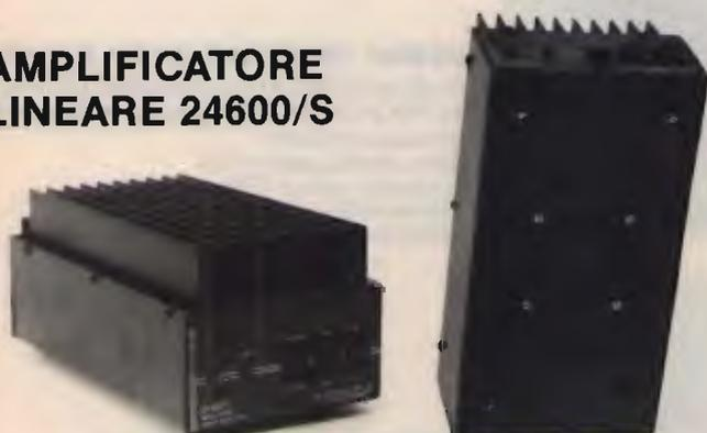
L'amplificatore lineare 24600/S è un ottimo amplificatore per utilizzo da 3 a 30 MHz con alimentazione a 24 Volt. È particolarmente indicato per camion o imbarcazioni dove è necessario ottenere alte prestazioni in dimensioni e pesi contenuti. L'amplificatore è infatti dotato di una ventola di raffreddamento che mantiene la temperatura del dissipatore su valori accettabili anche per un uso prolungato.
