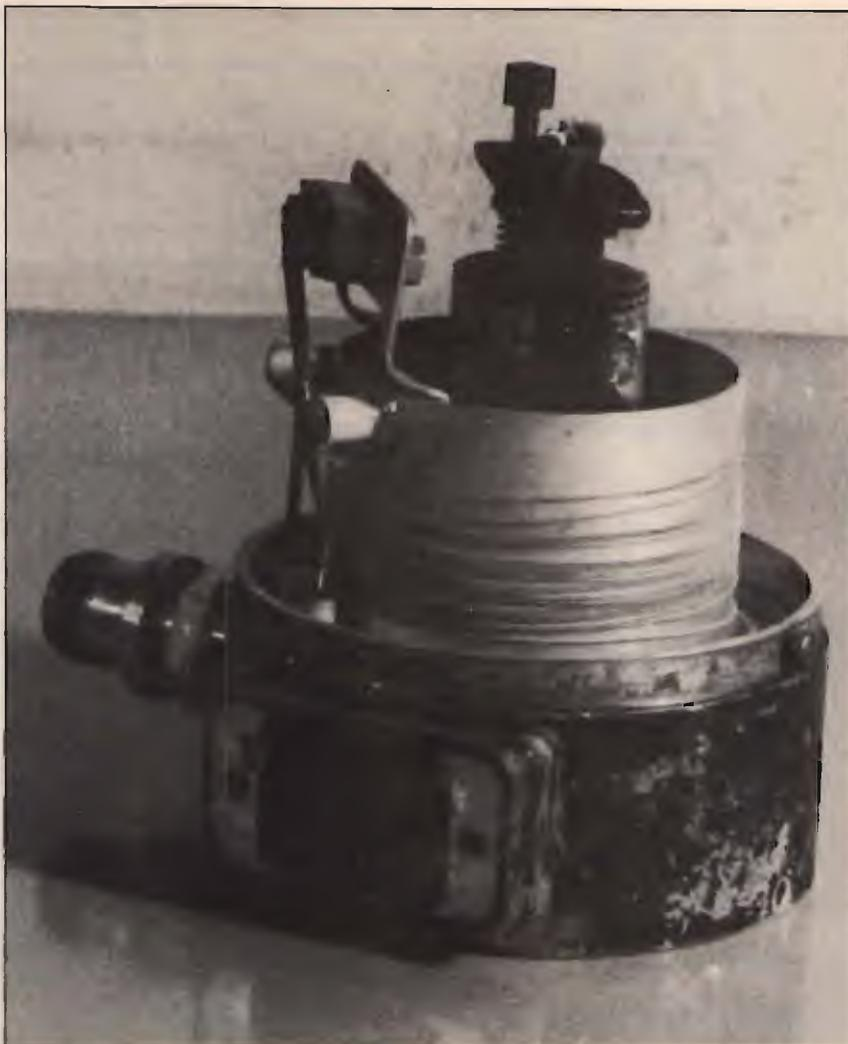
COV-1 mixer. Questo è identico a COV-2 che rispetto a COV-1 include un klystron 726/A invece di un klystron TK-8, ma per il resto è identico.
