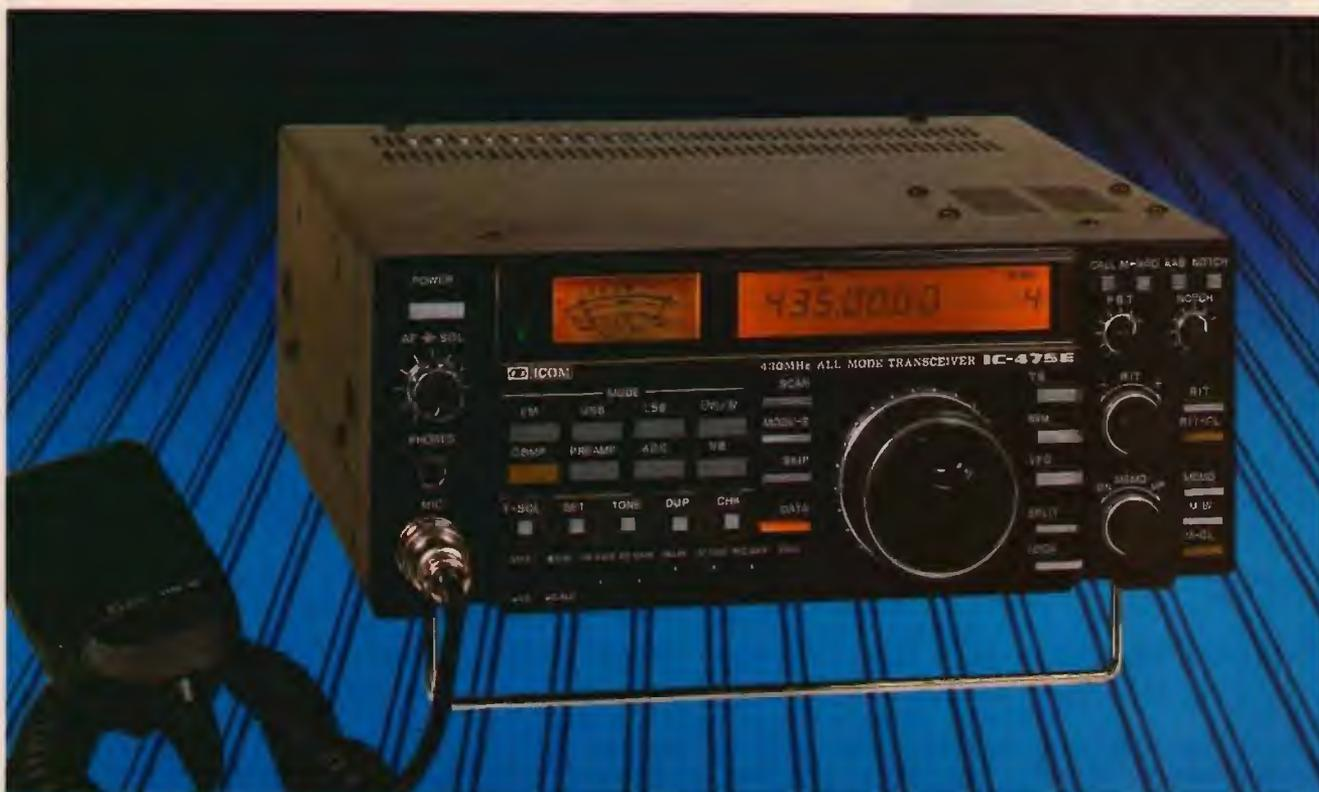
Il ricetrasmittitore si distingue dai precedenti modelli in quanto incorpora un sintetizzatore estremamente rapido, impiegante soli 5 ms per adeguarsi ad una nuova frequenza compatibilmente ai nuovi modi di comunicare: AMTOR, PACKET e RTTY. Per tale scopo l'ICOM ha progettato un nuovo circuito PLL, il quale elabora in frazioni di secondo il segnale generato dal sintetizzatore in un nuovo doppio circuito con caratteristiche del tutto particolari.
