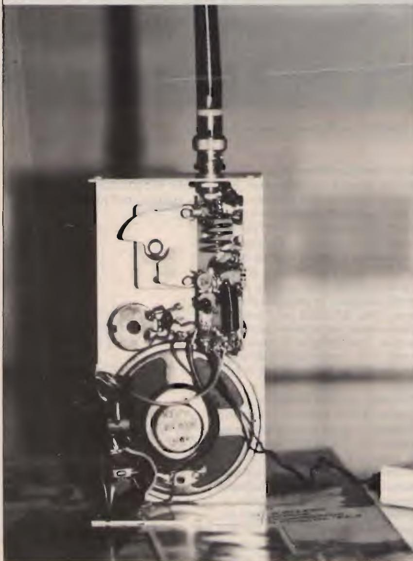
statore; in questo caso si avranno i circa 10 pF occorrenti per la sintonia. Una nota positiva è che il rotore del variabile va a massa per cui non solo non vi sono capacità parassite introdotte dalla mano, ma il circuito può essere racchiuso in un contenitore metallico.
