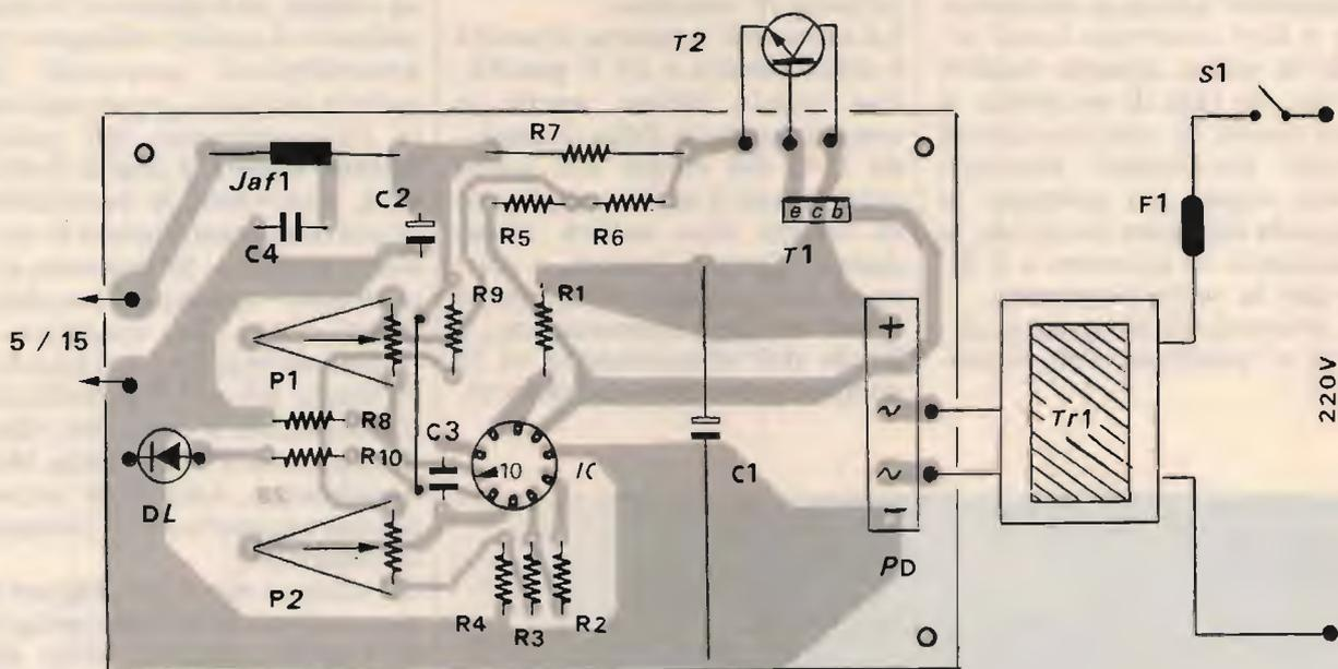
partitore R5/R6, si può regolare la corrente tra 0,1 e 2 ampere, mentre con il potenziometro P2 si può regolare la tensione tra 5 e 15 Volt. Il potenziometro P2 è collegato al partitore R3/R4 e alla resistenza R9; modificando il valore di R4 e R9 è possibile ottenere una diversa escursione della tensione di uscita. Per il
