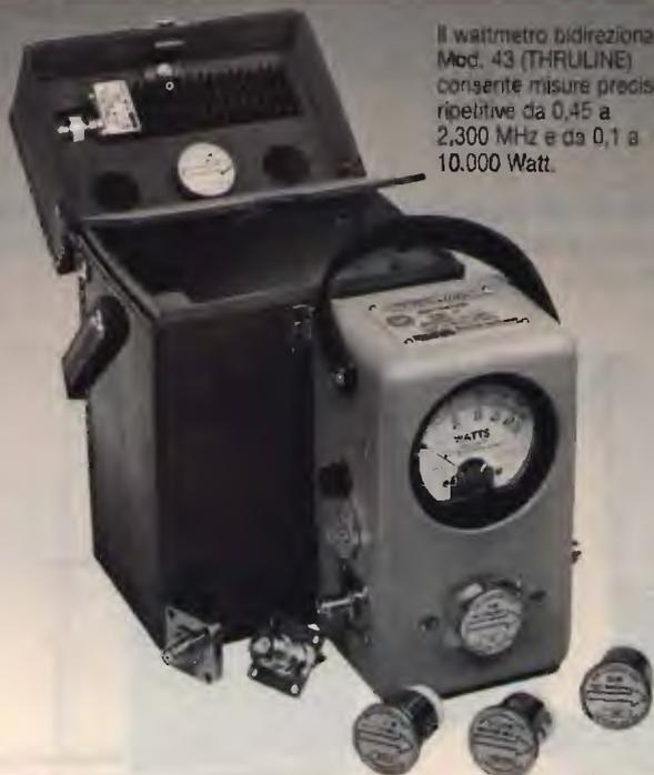
Il wattmetro bidirezionale Mod. 43 (THRULINE) consente misure precise e ripetitive da 0,45 a 2.300 MHz e da 0,1 a 10.000 Watt.
