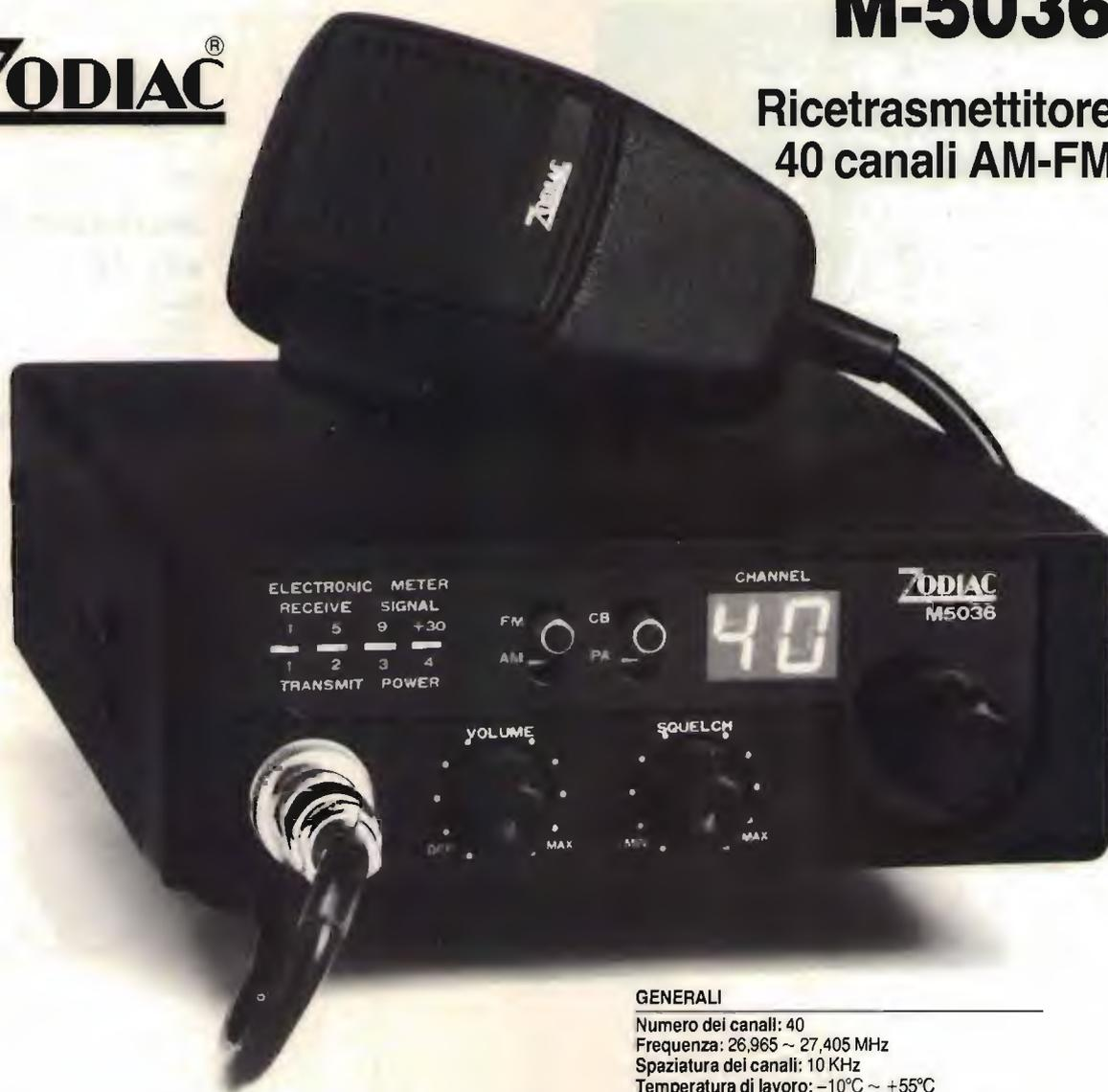
Ricetrasmittitore AM/FM per uso veicolare, completamente transistorizzato. Un circuito sintetizzatore di frequenza fornisce 40 canali, sia in TX che in RX.
