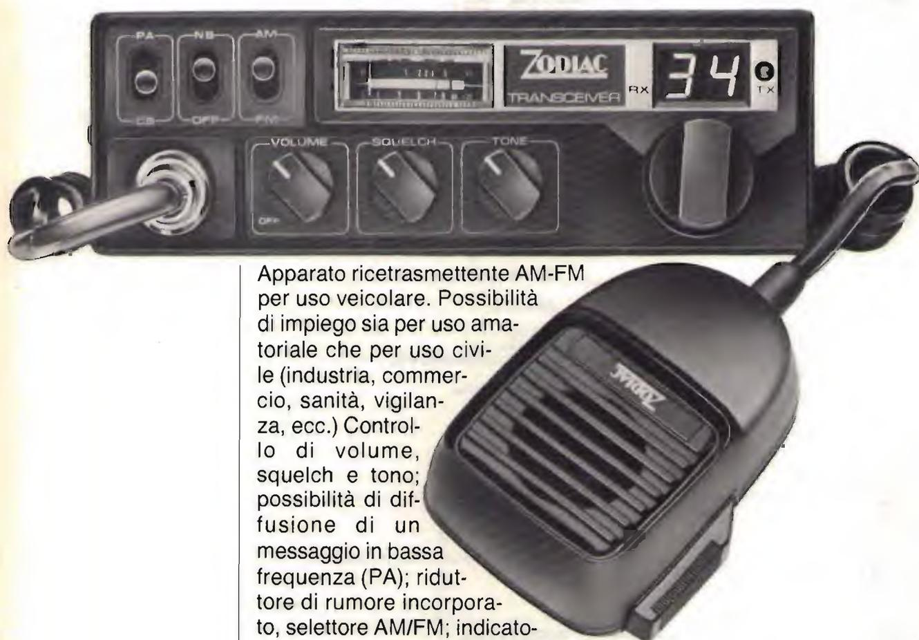
Apparato ricetrasmittente AM-FM per uso veicolare. Possibilità di impiego sia per uso amatoriale che per uso civile (industria, commercio, sanità, vigilanza, ecc.) Controllo di volume, squelch e tono; possibilità di diffusione di un messaggio in bassa frequenza (PA); riduttore di rumore incorporato, selettore AM/FM; indicatore a led di funzione RX e TX; indicatore di canale a display; strumento indicatore della potenza RF in uscita e dell'intensità del segnale in arrivo.
