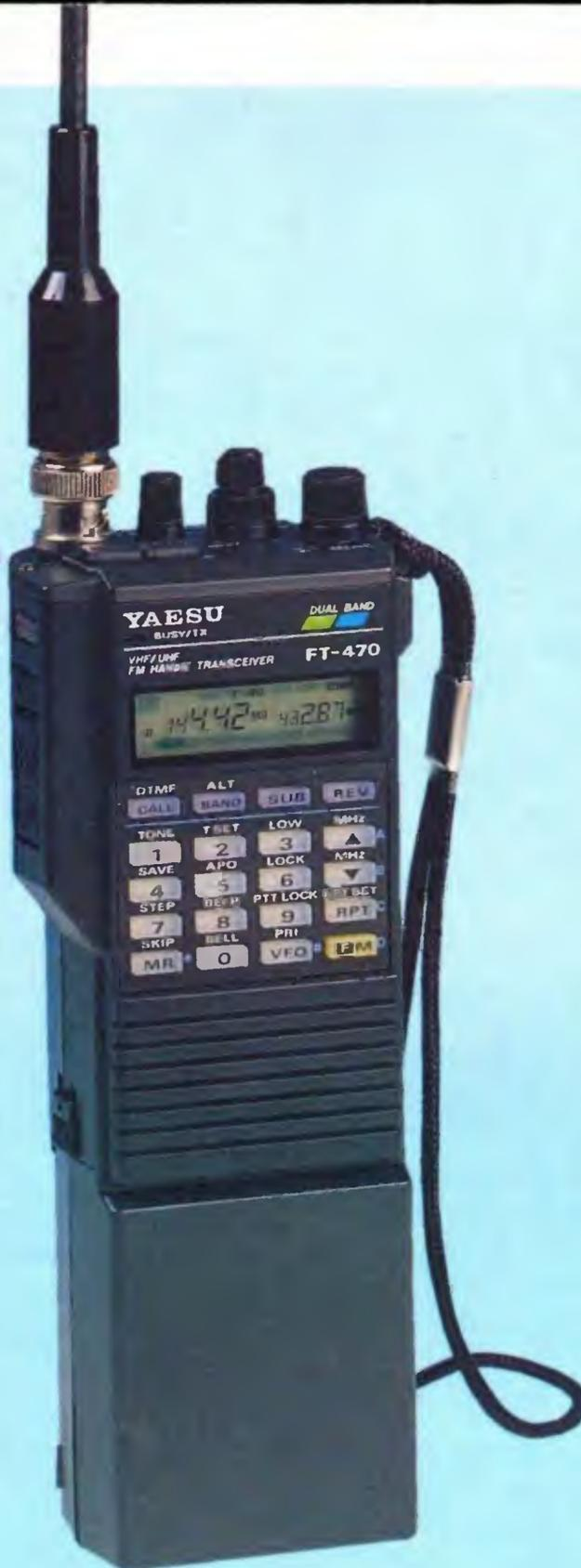
Costituisce un balzo aggiuntivo verso la miniaturizzazione integrale e la riduzione sui consumi senza alcun detrimento alle caratteristiche operative. L'ossatura dell'apparato è realizzata in alluminio raggiungendo pregevoli caratteristiche di schermatura e solidità.
