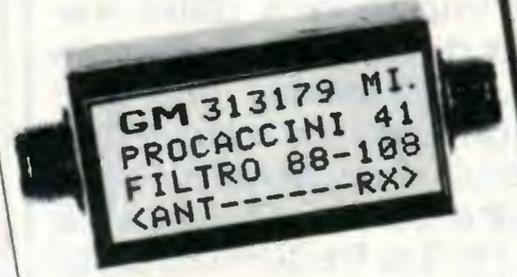
Filtro anti disturbo per ricevitori scanner (attenuatore della banda 88-108) utilizzabile anche in trasmissione per apparati in 2 m.
