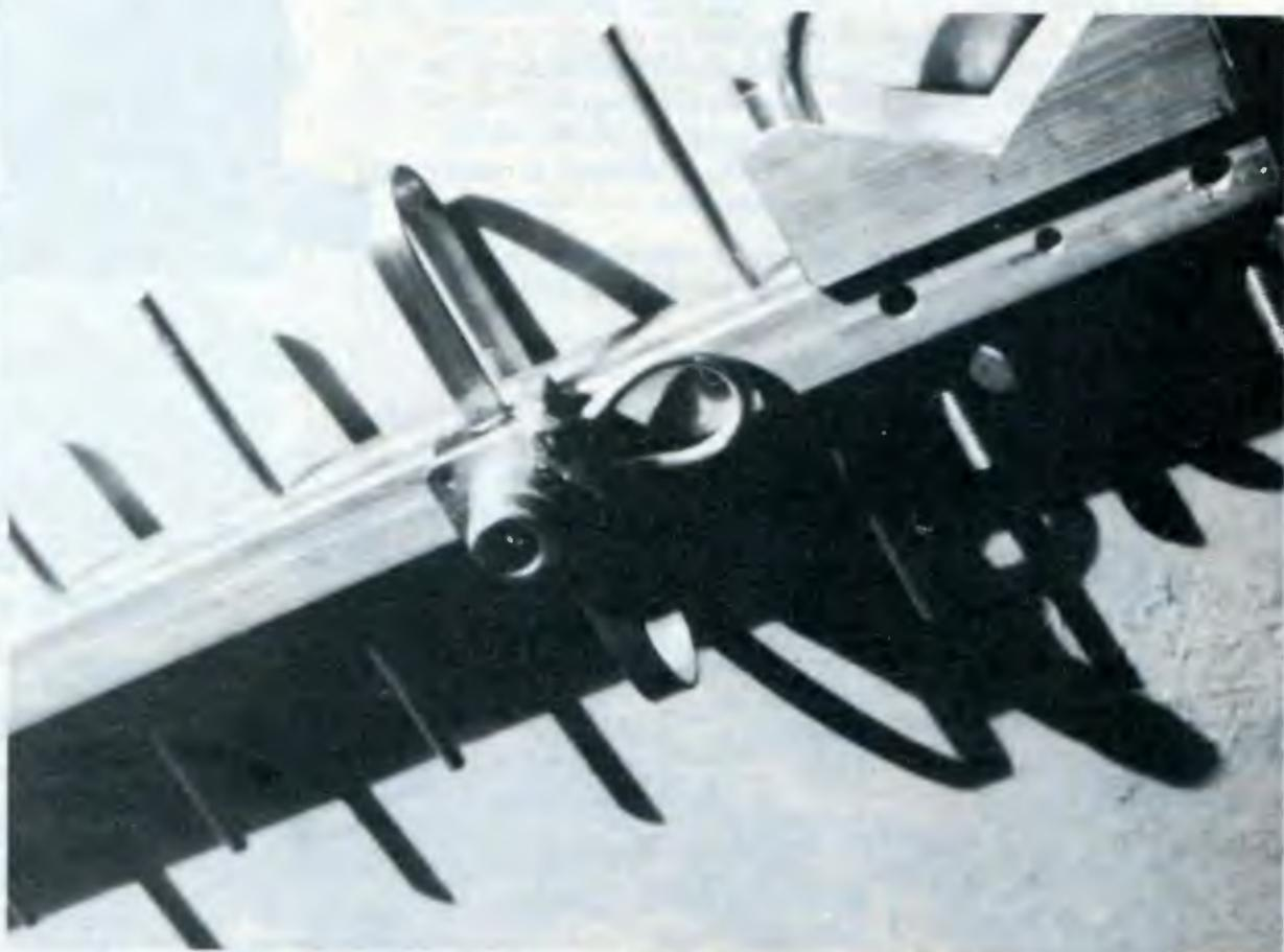
Yagi per 23 cm, dettaglio dipolo.
