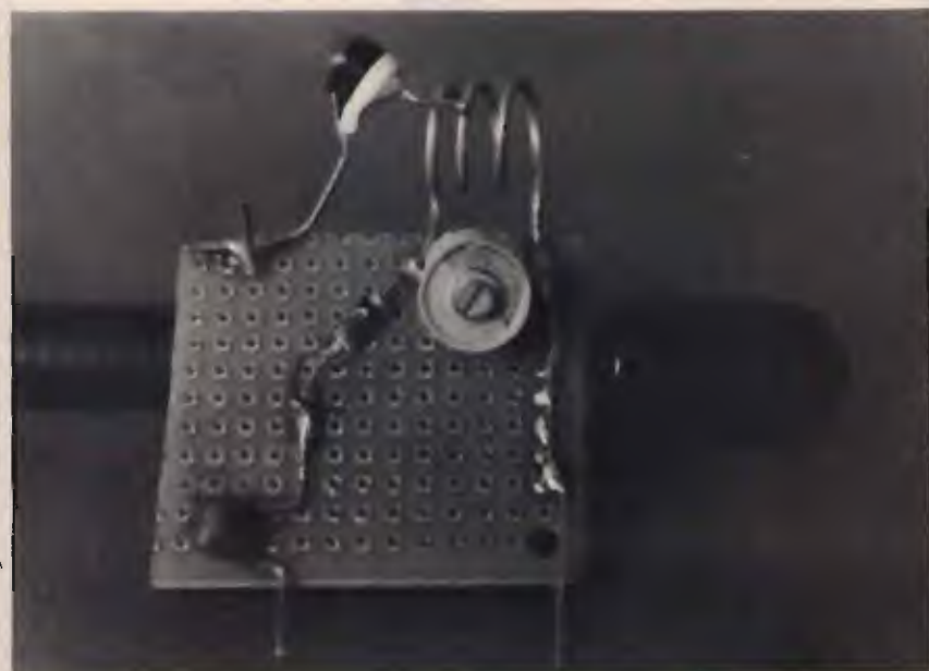
Un prototipo di laboratorio del moltiplicatore di frequenza, a montaggio ultimato.
