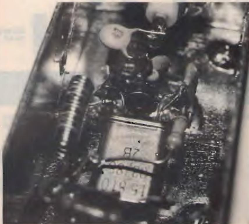
Particolare ingrandito del condensatore di accoppiamento.
