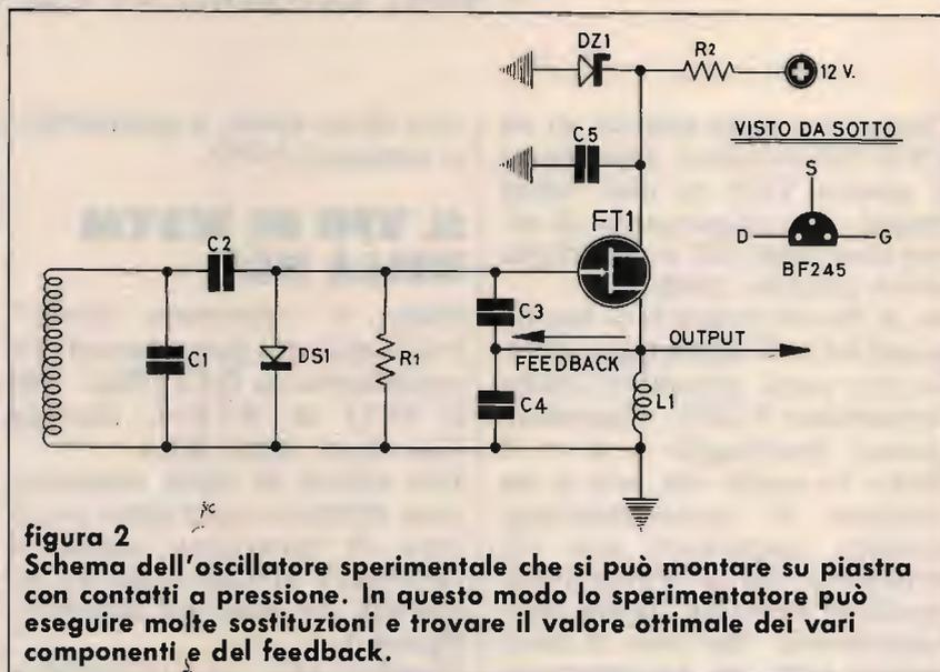
figura 2 Schema dell'oscillatore sperimentale che si può montare su piastra con contatti a pressione. In questo modo lo sperimentatore può eseguire molte sostituzioni e trovare il valore ottimale dei vari componenti e del feedback.
