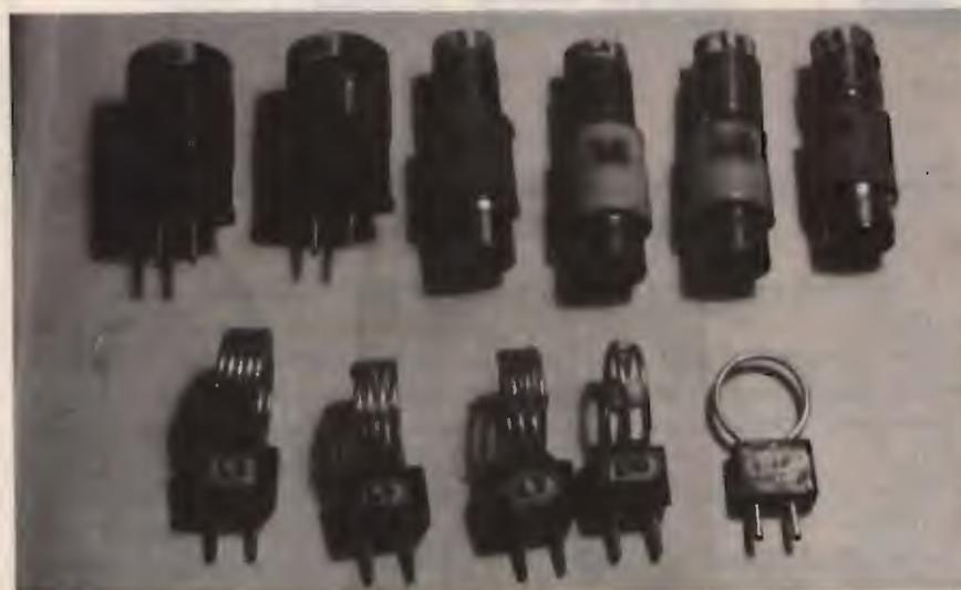
Il set completo di bobine "LX" intercambiabili. Perché le bobine in basso (da L7 a L11) possano inserirsi correttamente nella presa DIN, occorre mantenere una distanza, tra i piedini, pari a 8,5 mm.
