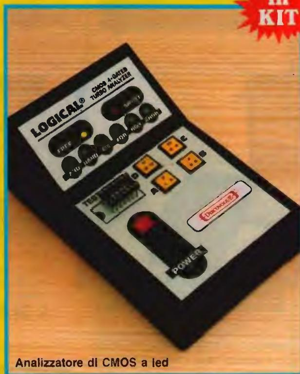
Analizzatore di CMOS a led
