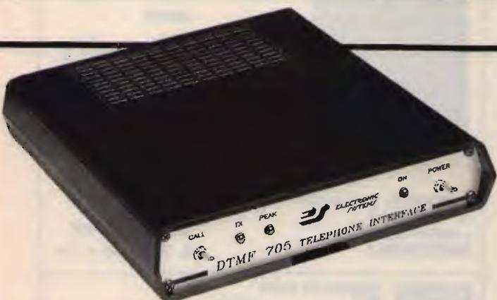
L'Interfaccia Telefonica dà la possibilità di collegarsi via radio alla propria linea telefonica e permette di effettuare o rispondere alle telefonate. Può essere collegata a qualsiasi apparato ricetrasmittente AM o FM in Simplex o Duplex. DI FACILE INSTALLAZIONE. Caratteristiche tecniche principali:
