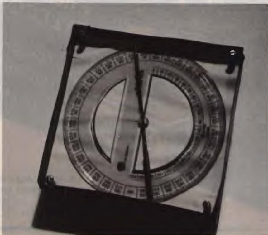
tro a 360 gradi con un diametro minimo di 8 cm e massimo di 12 cm, in caso non si trovi un tale goniometro si può sopperire al caso con 2 da 180°; poi da un falegname ci si procura una tavoletta di legno dolce, pino ad esempio, con dimensioni appropriate al diametro del goniometro. Esempio: goniometro di diametro 10 cm, tavoletta di 11 x 11 cm, lo spessore di tale tavoletta deve essere di circa 2,2/2,5 cm perfettamente squadrata e liscia, oltre a questa, un'altra di cm 8 x 4 stesso spes-
