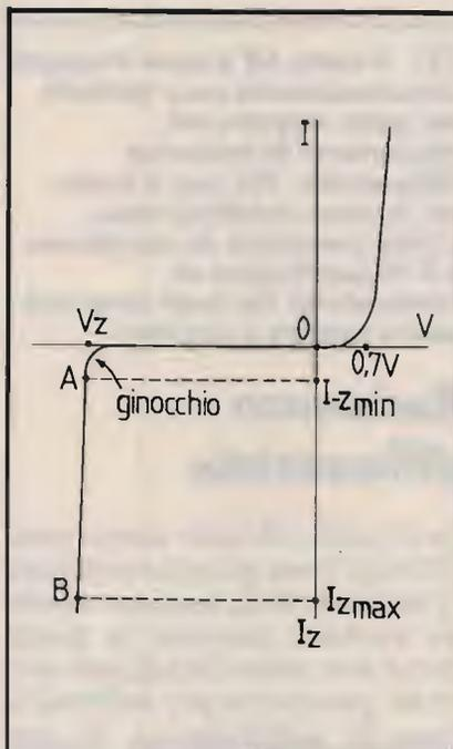
① **Curva caratteristica di un diodo zener. Per un corretto funzionamento come stabilizzatore di tensione, lo zener deve lavorare nel tratto AB, il che si ottiene con un corretto dimensionamento della resistenza limitatrice.**
