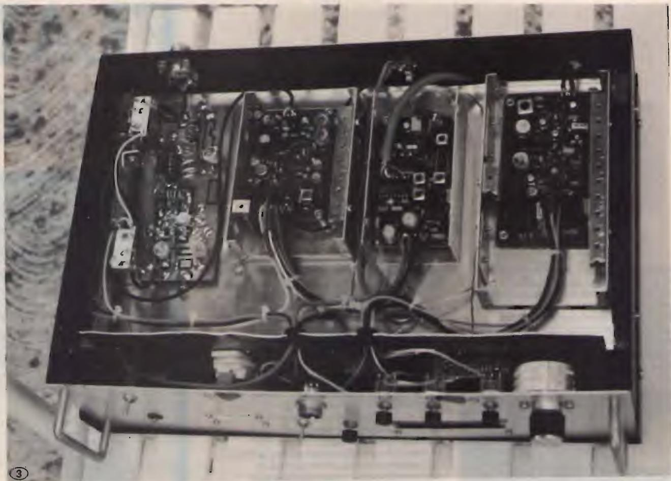
un B3-12 ho sostituito il finale MRF237 con un 2N3866 per pilotare poi il B3-12 visibile a sinistra nella foto.
