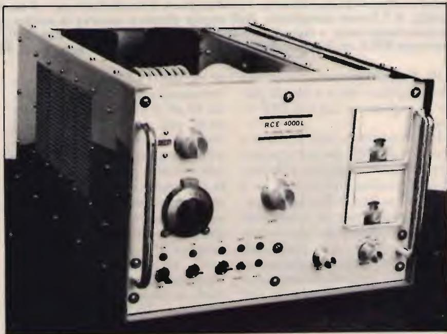
⑥ **Pannello frontale.** In alto a sinistra il contagiri per il condensatore di TUNE. Subito sotto, la manopola demoltiplicata per il condensatore di LOAD. Comandi operativi e indicatori luminosi sono raggruppati in basso a sinistra. In basso a destra la manopola dell'ALC e il selettore per lo strumento multiplo. Al centro, il selettore per la banda operativa. In alto a destra lo strumento per la corrente di placca; subito sotto, il multimetro.
