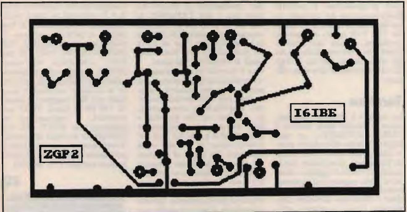
Indicatore di sintonia RTTY circuito stampato scala 1:1 lato rame.
