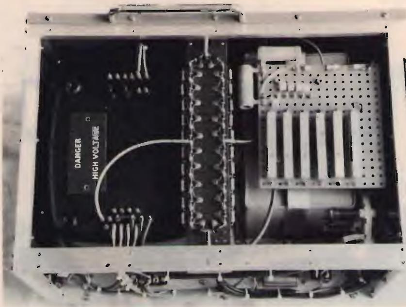
**12** L'alimentatore ad alta tensione visto dal basso. Al centro, la basetta con lo stadio raddrizzatore. A destra, sopra ai condensatori di filtro, la basetta con le resistenze di scarico per l'alta tensione, le resistenze moltiplicatrici per il voltmetro ad alta tensione e i due fusibili in serie. I due componenti perpendicolari tra loro, sui lati della basetta, formano la resistenza R3 per la soppressione delle scariche ad arco: sono due resistenze da 50  $\Omega$ , 25 W, in parallelo.
