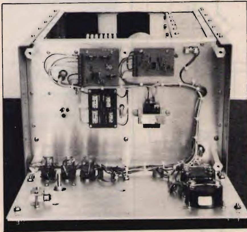
9 Il pannello frontale smontato. In alto a sinistra i circuiti di regolazione del wattmetro; in alto a destra il rilevatore di errore per la tensione dei filamenti. La bassetta e il piccolo trasformatore al centro costituiscono l'alimentatore per il wattmetro di picco.
