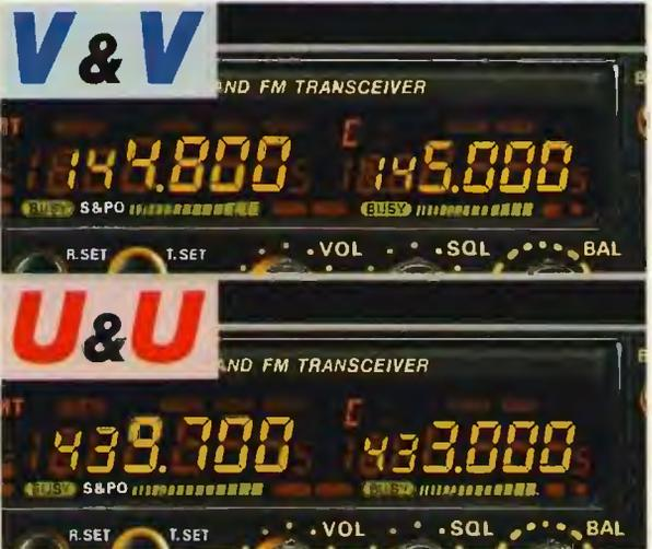
Esempio di ricezione simultanea di due frequenze nella stessa banda
