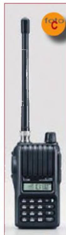
teres), tonos CT-CSS y DCS, control VOX (ajustable) para operación con manos libres, batería de larga duración, tono de 1750 Hz para acceso a repetidores, y puede ser programado desde un ordenador mediante software y cable opcionales. En cuanto a sus especificaciones técnicas, opera en FM con desviación de frecuencia seleccionable entre  $\pm 5$  kHz y  $\pm 2,5$  kHz, la potencia de salida es seleccionable (5/ 2,5/0,5 va-
