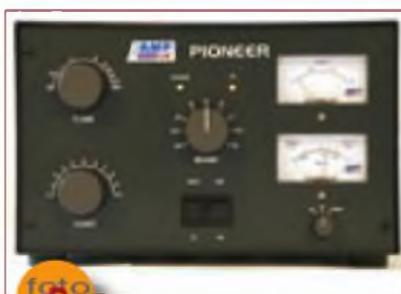
das con rejilla a masa y neutralización total, entrega hasta 1000 vatios PEP en SSB, hasta 600 vatios en CW, y hasta 400 vatios en RTTY y otros modos digitales, para un ciclo de trabajo del 50%. Su ganancia es de 10 dB, y la potencia máxima de entrada es de 100 vatios. Se recomienda que no sea sometido a una ROE superior a 1,5:1 (nunca ha de ser superior a 2:1). La reducción de armónicos es (valor típico respecto PEP) de 50 dB.
