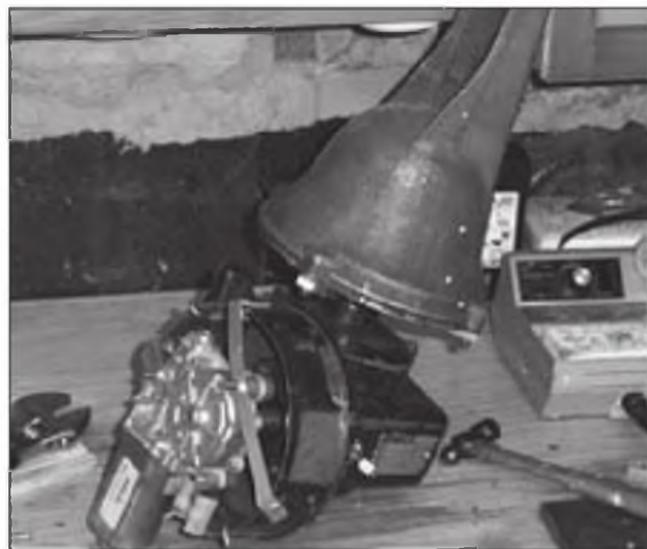
Foto B. Mi super-rotor de construcción casera utiliza un potente motor de elevalunas de coche y una carcasa de un viejo rotor para soportar el mástil y un potente reductor de tornillo sinfín. Utilizo la placa Arduino Uno para controlar el motor y detectar la dirección a la que apunta la antena.
