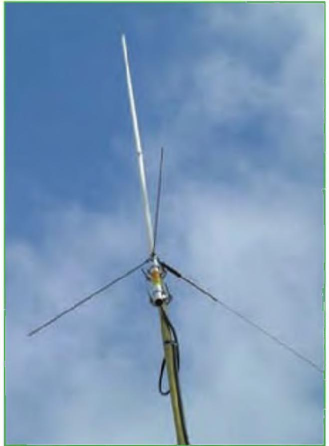
Foto 4. Una sencilla antena como ésta, junto con una estación convencional para radiopaquete a 1200 baudios en la banda de 2 metros, es todo lo necesario para realizar comunicados de radiopaquete a través de la Estación Espacial Internacional. ¡Inténtalo!
