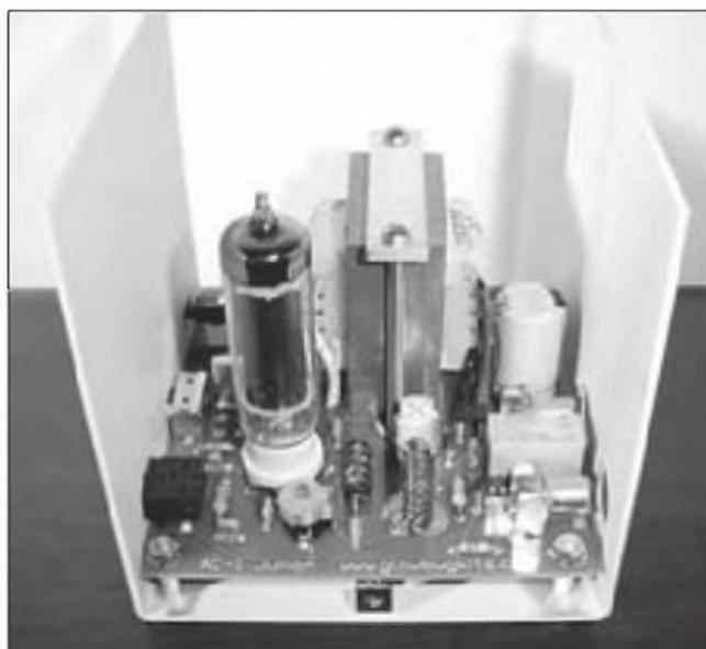
Foto E. Vista del interior del Glowbug. Observa el único toroide cerca del panel frontal y el transformador de alimentación montado de lado para que encaje mejor.
