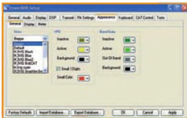
Foto G. Menú desplegable con las varias configuraciones que podemos escoger para la apariencia del programa PowerSDR en el que se muestran muchas más variantes para la carátula del panel principal del transceptor.
