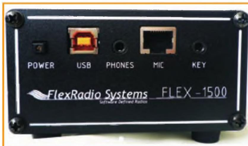
Foto B. Panel frontal del Flex-1500 en el que se pueden ver de izquierda a derecha el pulsador de puesta en marcha, el conector de micrófono RJ-45, el mini-jack estéreo para los auriculares y el mini-jack estéreo para el manipulador, ya sea vertical o de palas laterales.
