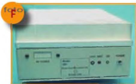
Asimismo, DEMI ofrece montados o en kit otros transversores de mayores prestaciones (foto F), para las bandas de 50, 70, 144 o 432 MHz; rediseñados en 2010, cuentan con un factor de ruido menor de 0,8 dB, ganancia mayor de 17 dB, potencia de salida mayor de 25 o 50 W (según versión), secuenciador incluido opcional, etc. También cuentan en catálogo con transversores para las bandas de 1296 MHz y superiores. Visitar el sitio web <http://www.downeastmicrowave.com>.
