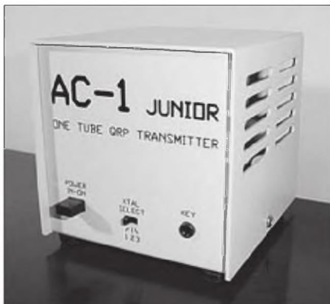
Foto D. Panel frontal del transmisor de CW Glowbug para 40 m (fotos de los Glowbug cedidas por Dwight Morrison, KG4HSY).
