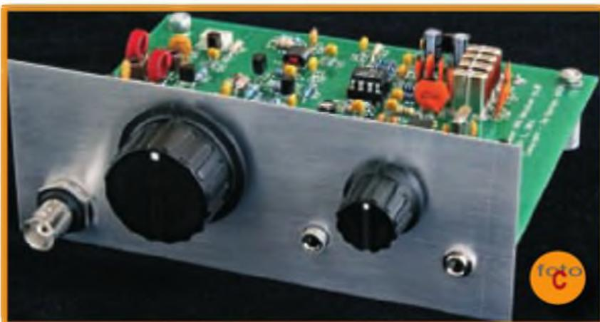
mínima señal distinguible nada menos que -132 dBm), 500 Hz de ancho de banda con un buen factor de forma gracias al filtro de cristal incluido, oscilador variable VXO con cobertura
