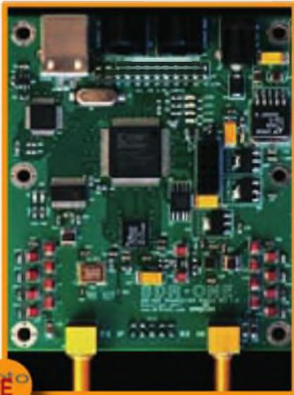
do externa, con conector S/PDIF si se desea realizar la transferencia de datos I/Q digitalmente. El SDR-ONE, con unas medidas de 7,5 x 9 cm, podrá ser utilizado como placa transmisora/receptora de FI en transceptores, analizador de espectro, gene-
