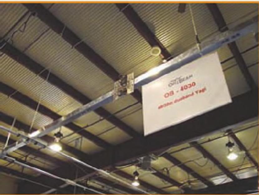
Foto O. La antena direcciva Opti-Beam 4030 es una gigantesca Yagi bibanda que cubre los 40 y los 30 metros.
