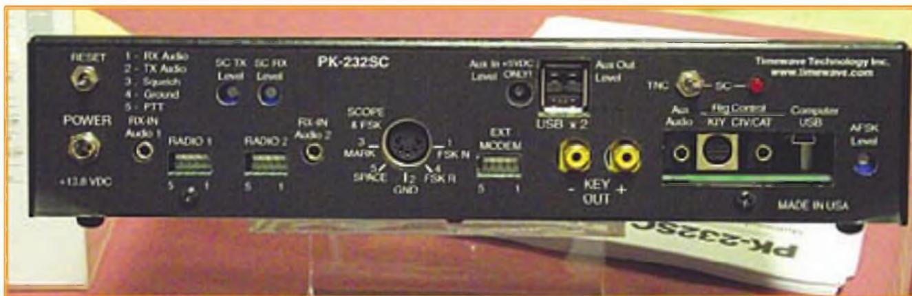
Foto J. El panel posterior del PK-232SC de Timewave Technologies, toda una interface digital. Observa los dos puertos USB. Además, contiene un distribuidor de 4 puertos USB (hub) en su interior.
