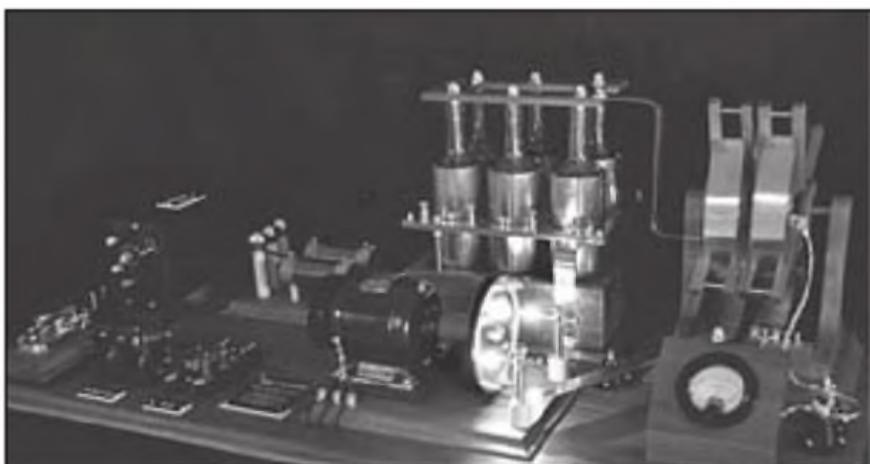
Foto A. Transmisor de chispa rotativa de 500 vatios construido por Hal, N4GG. Se muestra emitiendo entre 200 y 300 vatios, con los que ¡el arco es de 2000 amperios!
