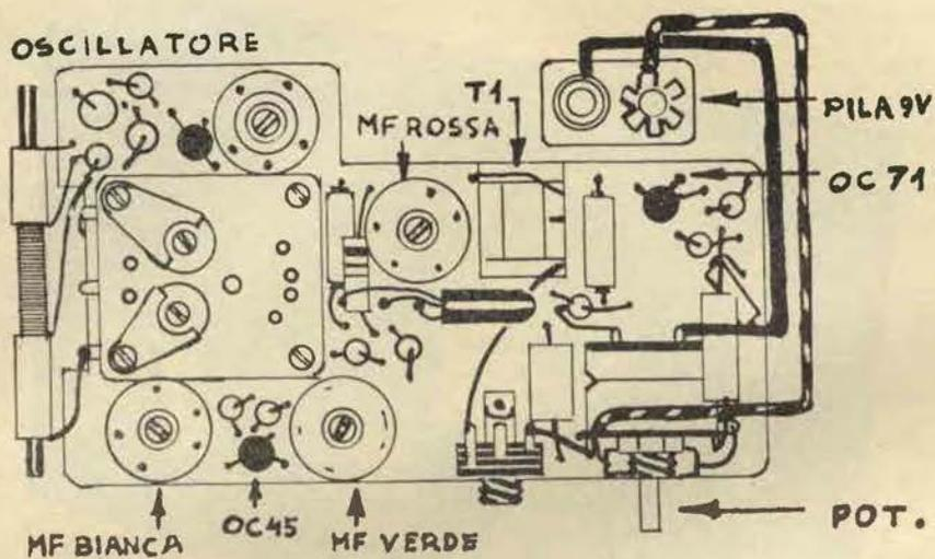
Lato superiore del cablaggio del circuito stampato: si noti la disposizione dei vari componenti ed i collegamenti alla pila, alla bobina su ferrite, ecc.
