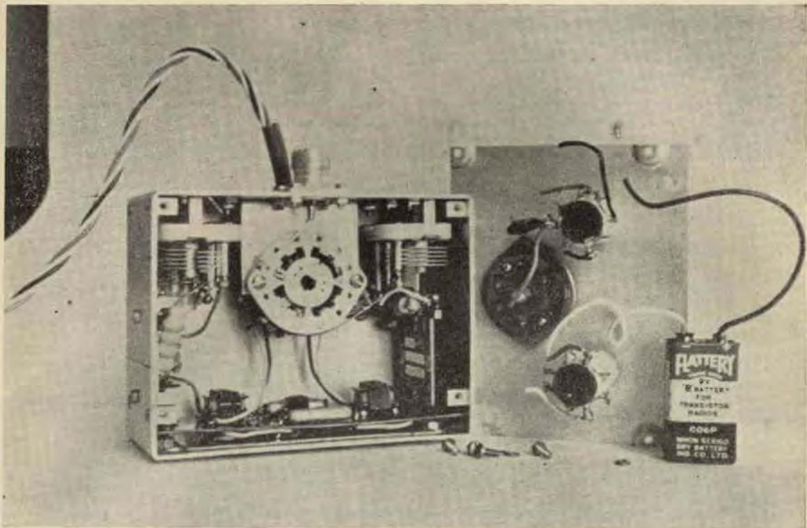
FOTO 1 - Il radiotelefono dalla parte del commutatore d'antenna.
