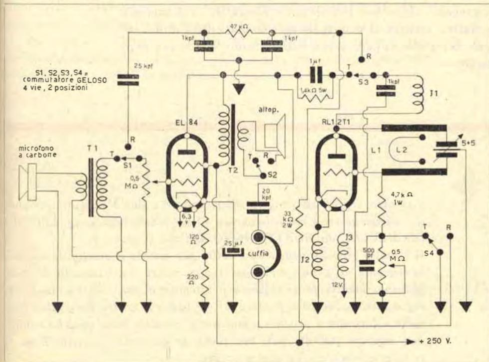
Tra i vari accorgimenti che non possiamo fare a meno di additare al lettore, è l'adozione di una « linea » per l'oscillatore (formata da filo argentato da 3 mm., lunga 7 cm., spaziata di mm. 11); inoltre tutte le altre intelligenti particolarità: quali, l'uso di un filtro anti-soffio in ricezione, l'assenza di commutazioni in radio-frequenza, l'adozione della EL84 quale modulatrice-stadio BF, che con la sua elevata sensibilità di potenza permette il diretto pilotaggio dal microfono
