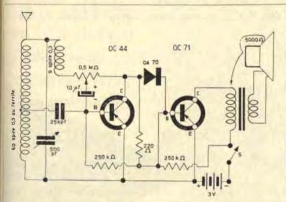
Schema elettrico del ricevitore del sig. Meucci.
