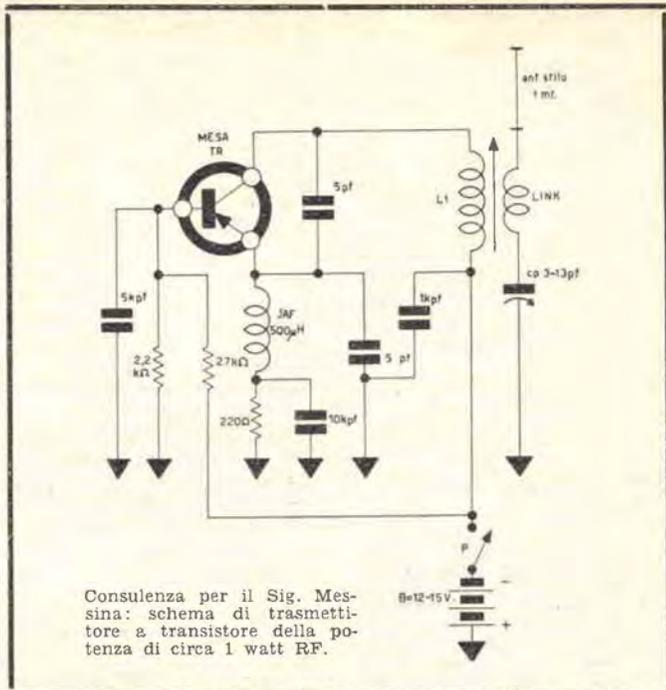
Consulenza per il Sig. Messina: schema di trasmettitore a transistoro della potenza di circa 1 watt RF.
