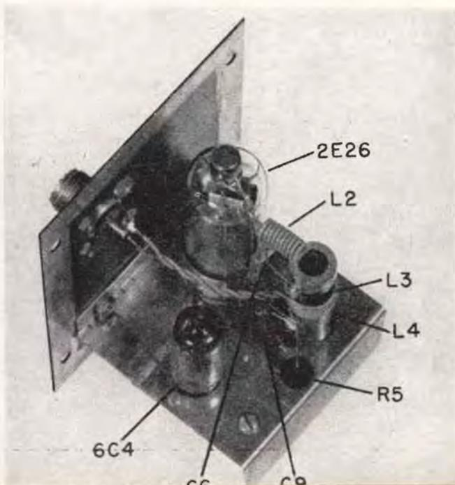
Aspetto del montaggio del trasmettitore di cui sopra.
