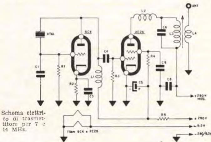
Schema elettrico di trasmettitore per 7 e 14 MHz.
