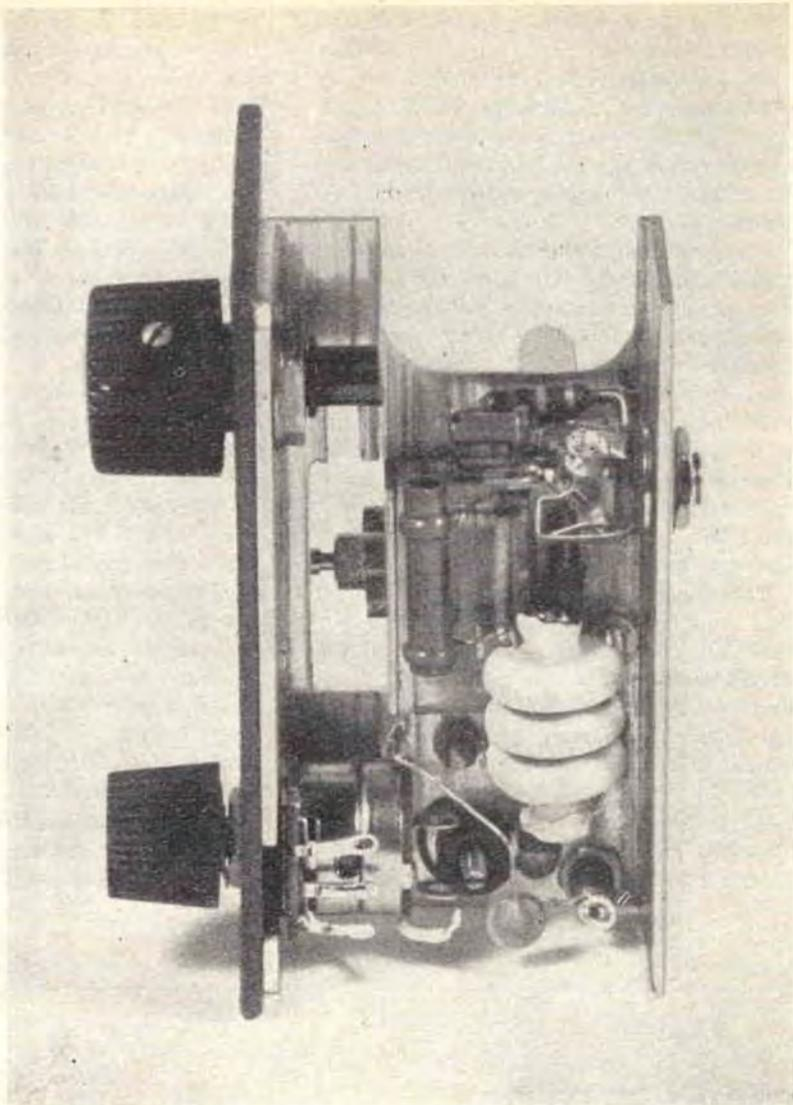
avvolgono tre spire serrate di filo rame smaltato di diametro 0,4 mm.
