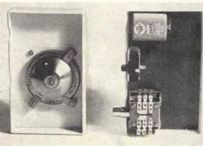
Prima del cablaggio: si noti che viene usato un tipo insolito di commutatore R-T, però nulla vieta di adoperare il più diffuso modello a slitta, meno comodo di questo (del tipo « a pulsante ») ma molto meno costoso e più reperibile.
