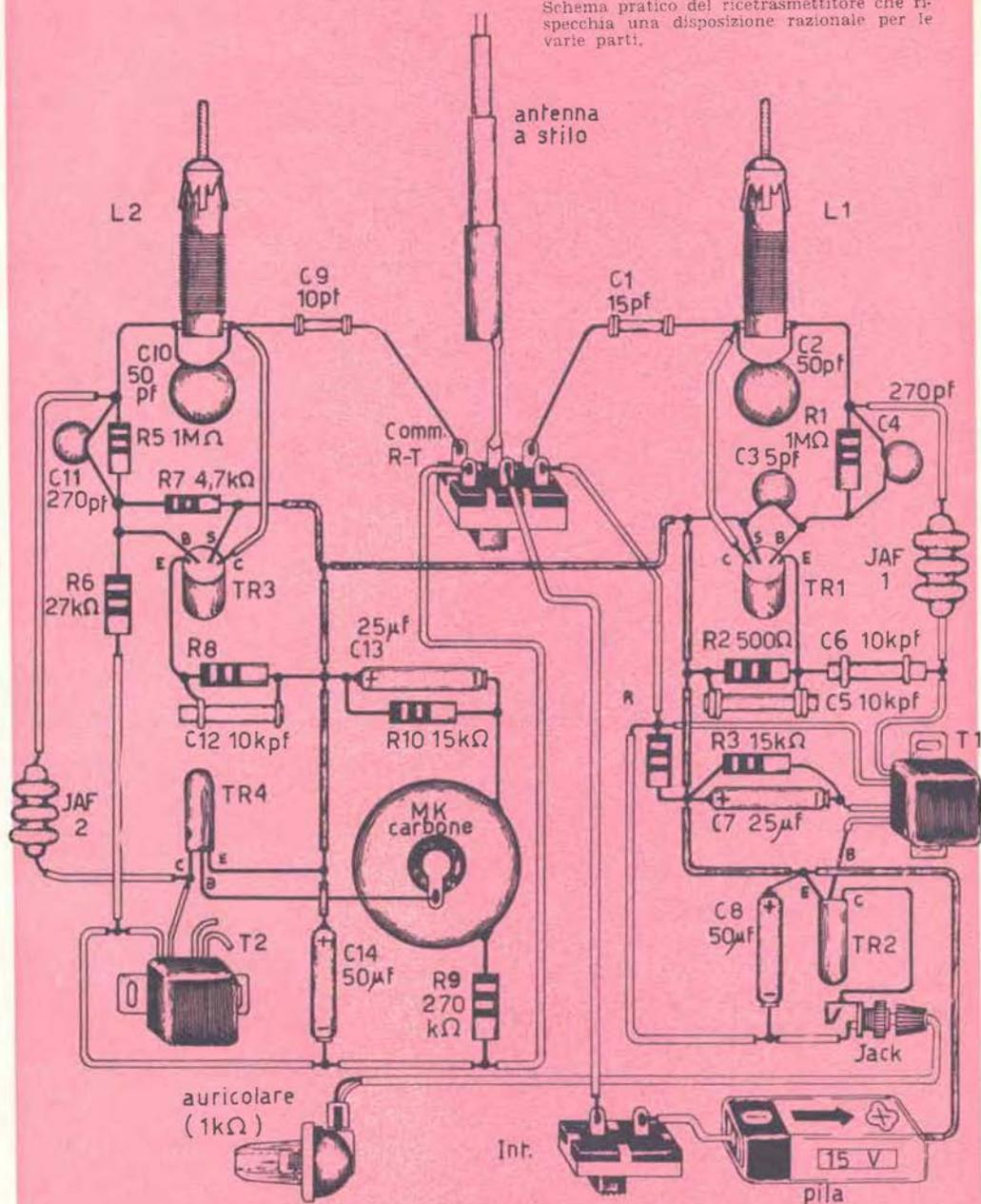
fio ci sia. Porteremo allora il commutatore in posizione « trasmissione » e proveremo a parlare davanti al microfono presso ad un ricevitore che possa ricevere la gamma dei 28MHz: se non avete fatto qualche errore potrete senz'altro udire l'emissione sintonizzando il ricevitore.
