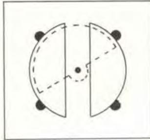
Lo schizzo a fianco raffigura la disposizione delle lamine di un condensatore differenziale. Sono chiaramente visibili i due statori separati (a tratto continuo) e l'unico rotore (punteggiato).
