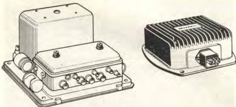
**Fig. 1 - Regolatore completamente transistorizzato senza contatti mobili; l'eccitazione viene regolata mediante rapide inserzioni e disinserzioni del campo dai transistori, i quali vengono comandati da un diodo zener.**
