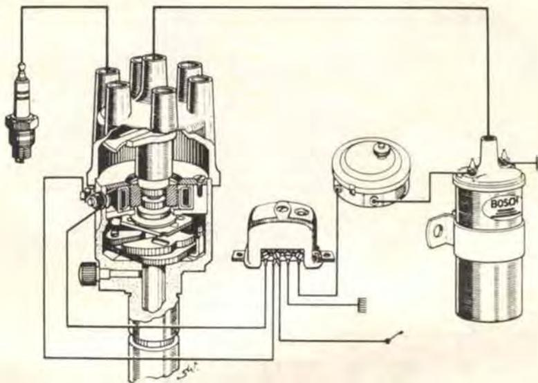
Occorre pertanto ridurre la tensione primaria se si vuole inserire un transistor; per ottenere ciò si deve ridurre l'induttanza primaria, ossia il numero di spire dell'avvolgimento primario.
