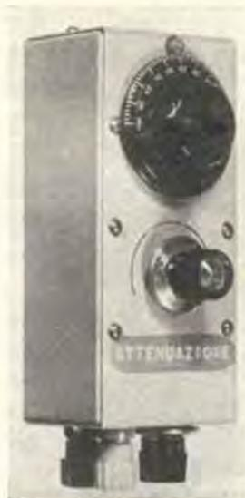
L'ondametro che presento consente di realizzare, senza bisogno di lunghe e complesse tarature e con modesta spesa, uno strumento idoneo alla rivelazione della radiazione elettromagnetica nella gamma da 1,7 MHz a 229 MHz a copertura completa.
