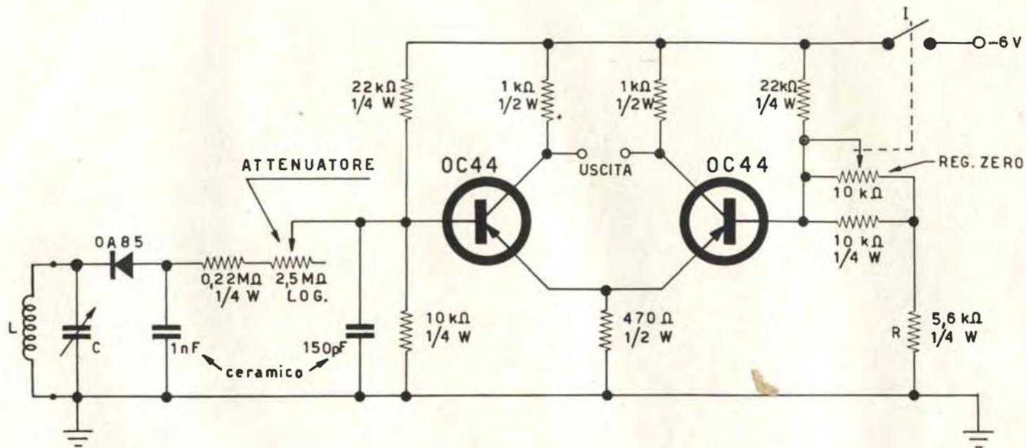
Fig. 1 - Schema elettrico ondmetro 1,73 - 229 MHz.
