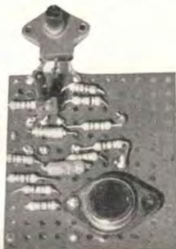
Il consumo dell'amplificatore risulta di poco superiore a 3 watt, e in tali condizioni non si presenta alcuna necessità di raffreddamento per l'OC26. Se la resistenza R6 fosse tale che il consumo dell'amplificatore s'avvicini al mezzo ampere, allora si renderebbe indi-
