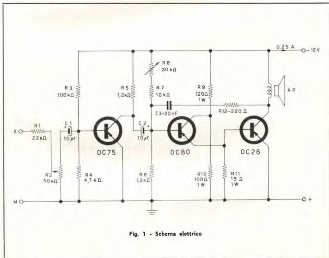
Fig. 1 - Schema elettrico
