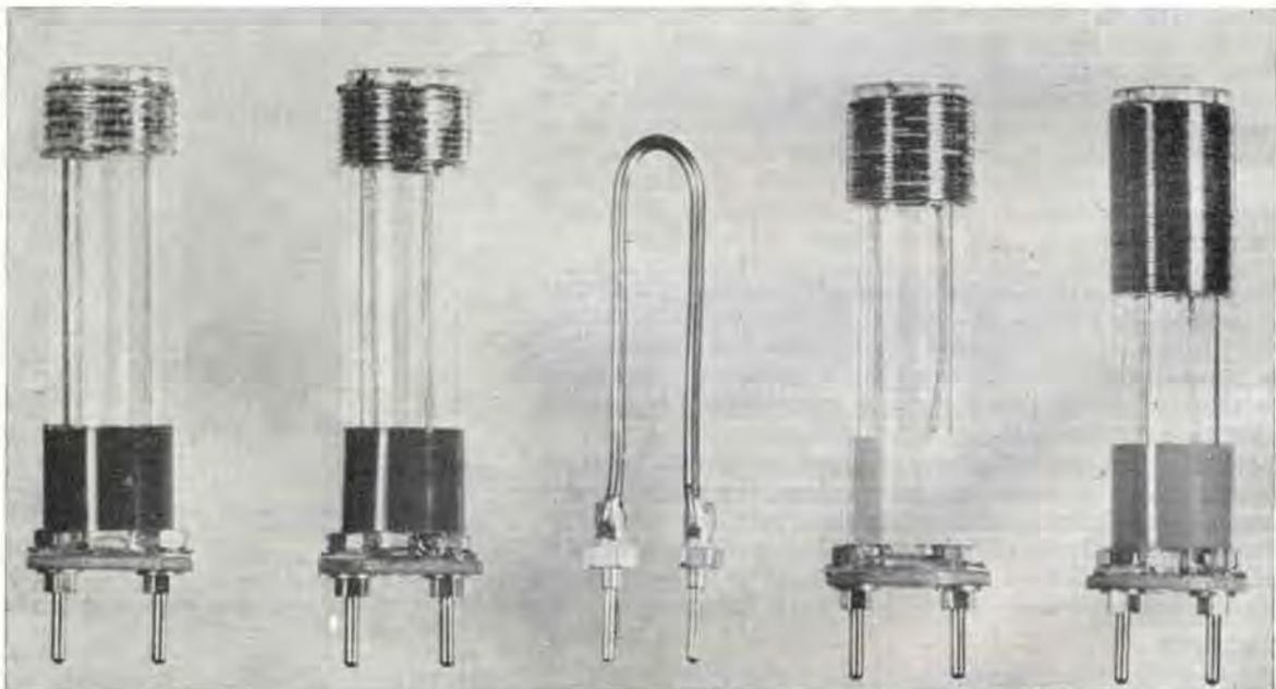
L'induttanza della gamma  $65 \div 210$  Mc è invece costituita da un filo di rame smaltato sagomato a forma di U. I dati relativi a queste induttanze sono riassunti nella apposita tabella. Ricordiamoci che si tratta di indicazioni di ordine generale poichè il campo di frequenza di ogni bobina è influenzato dal cablaggio, dalle capacità parassite e, naturalmente, soprattutto dal tipo di condensatore variabile usato.
