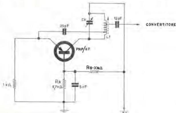
Questa è l'origine del difetto: la base del transistor oscillatore di conversione è alimentata dal rettificatore di rete, che eroga all'uscita fluttuazioni simili a quelle d'ingresso: per cui la tensione E+B dell'oscillatore riceve una polarizzazione che varia col variare della rete. Ora, come è noto, le capacità interne di un transistor, presenti fra i vari elementi che lo costituiscono, non sono fisse: ma variano col variare della tensione applicata
