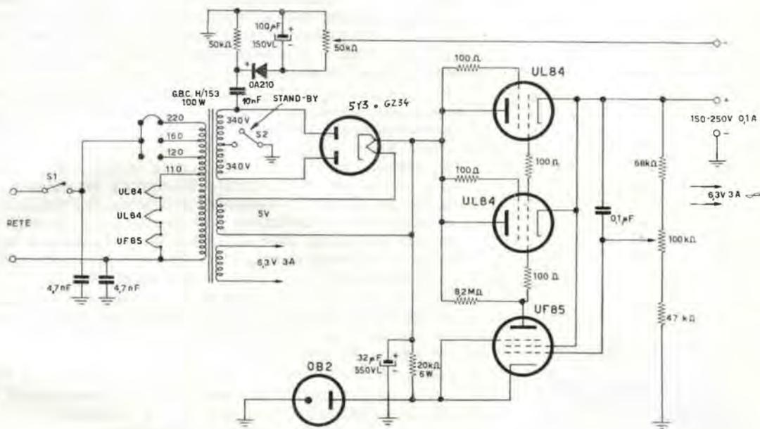
Facoltativo è l'uso di un voltmetro e di un milliamperometro all'uscita; si potrà anzi realizzare una scala sotto i potenziometri tarata direttamente in volt.
