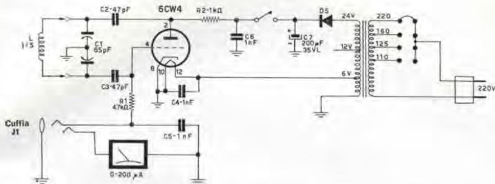
l'oscillatore quando entrambi sono sintonizzati sulla stessa frequenza; la perdita di energia è accompagnata da una diminuzione della corrente di griglia. La diminuzione (« dip ») della corrente di griglia è più ampia quando il circuito, al quale l'oscillatore è accoppiato ha un alto fattore di merito (Q).
