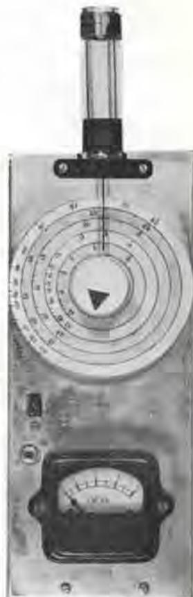
lida, significa che è proprio l'oscillatore che non funziona. Ci si può sincerare meglio di questo difetto iniettando il segnale del grid-dip direttamente nel selettore servendoci del « link » di cui abbiamo già accennato.
