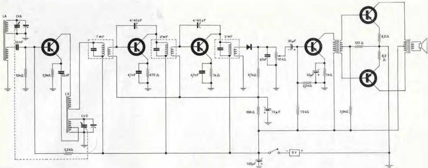
Supereterodina a 6 volt; LA è una bobina d'aereo su ferrite, normale, e LO è una altrettanto normale bobina d'oscillatore. CVA-CVO, variabile per super a transistor, a due sezioni. MF normali (« vecchio tipo ») e trasformatori pilota e d'uscita canonici (GBC).
