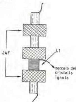
tina di spire di filo smaltato da 0,2 mm in una gola delle due che dividono l'avvolgimento totale dell'impedenza (fig. 2).
