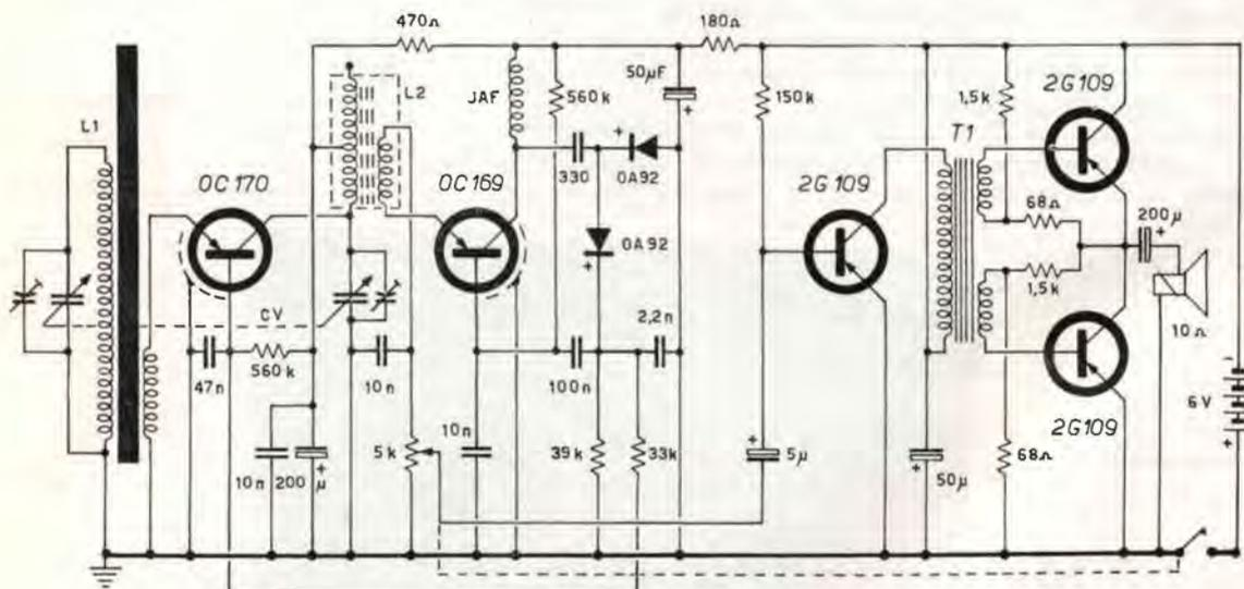
556 o G.B.C. 0/498-2) è inserita sul collettore e costituisce il carico per l'AF, ma pone praticamente a massa il collettore stesso per i segnali di Bassa Frequenza.
