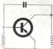
l'antenna è accoppiata con un condensatore di piccola capacità in testa al circuito oscillante; questo perchè ho previsto l'uso di una antenna notevolmente raccorciata rispetto al quarto d'onda. Chi volesse usare questo tipo di antenna, dovrà fare un accoppiamento a link su L1, come da figura
