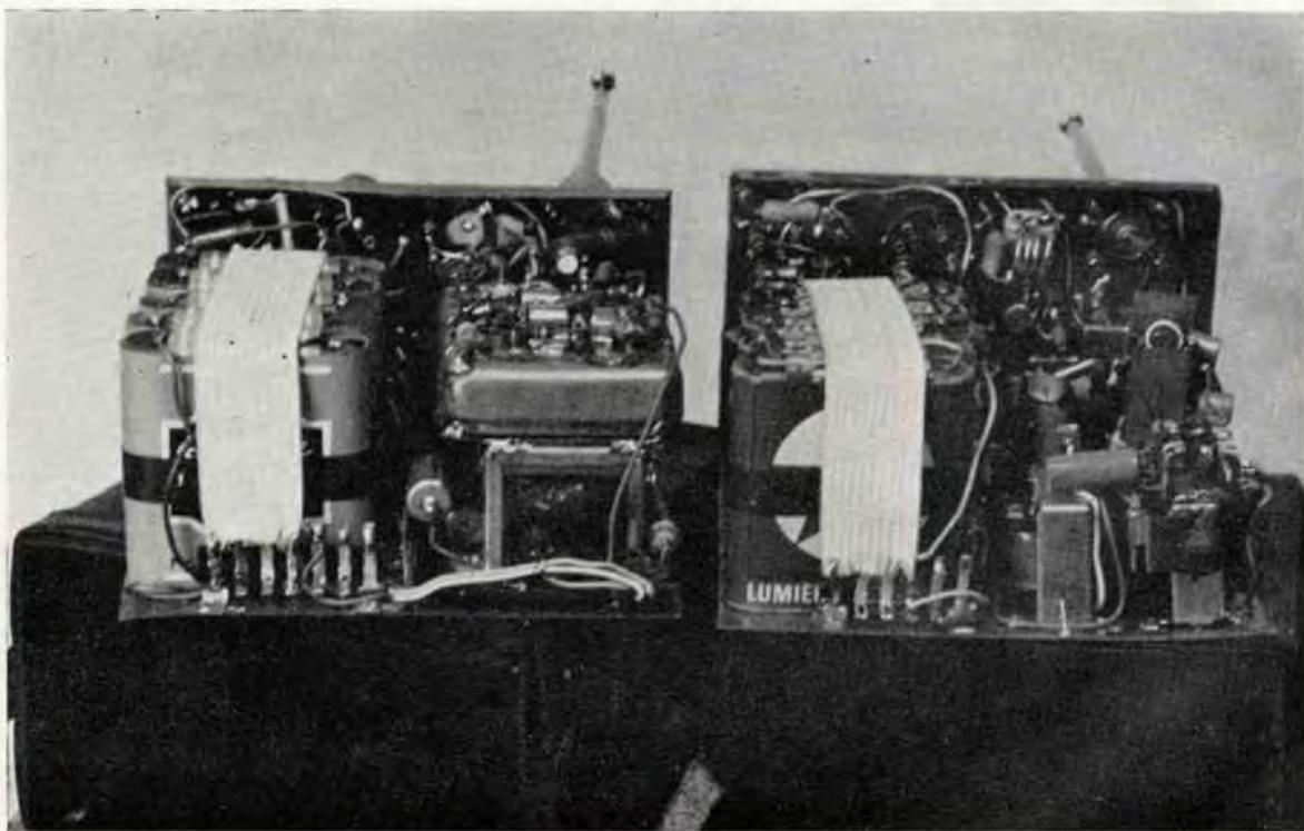
1° Secondario 60 spire filo di rame da 0,3 mm. 2° Secondario circa 1000 spire filo di rame da 0,15 mm. Come supporto si può usare il nucleo e relativi lamierini di un trasformatore per transistor tipo G.B.C. H/511; i due AC128 dovranno essere raffreddati con robusti radiatori di rame o con staffette di latta saldate al trasformatore di modulazione.
