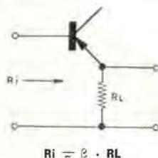
pertanto, assumendo  $R_s=500$  kohm, e  $h_{fe}=50$ , imponendo la condizione di adattamento, cioè  $R_i=R_s$ , si trova
