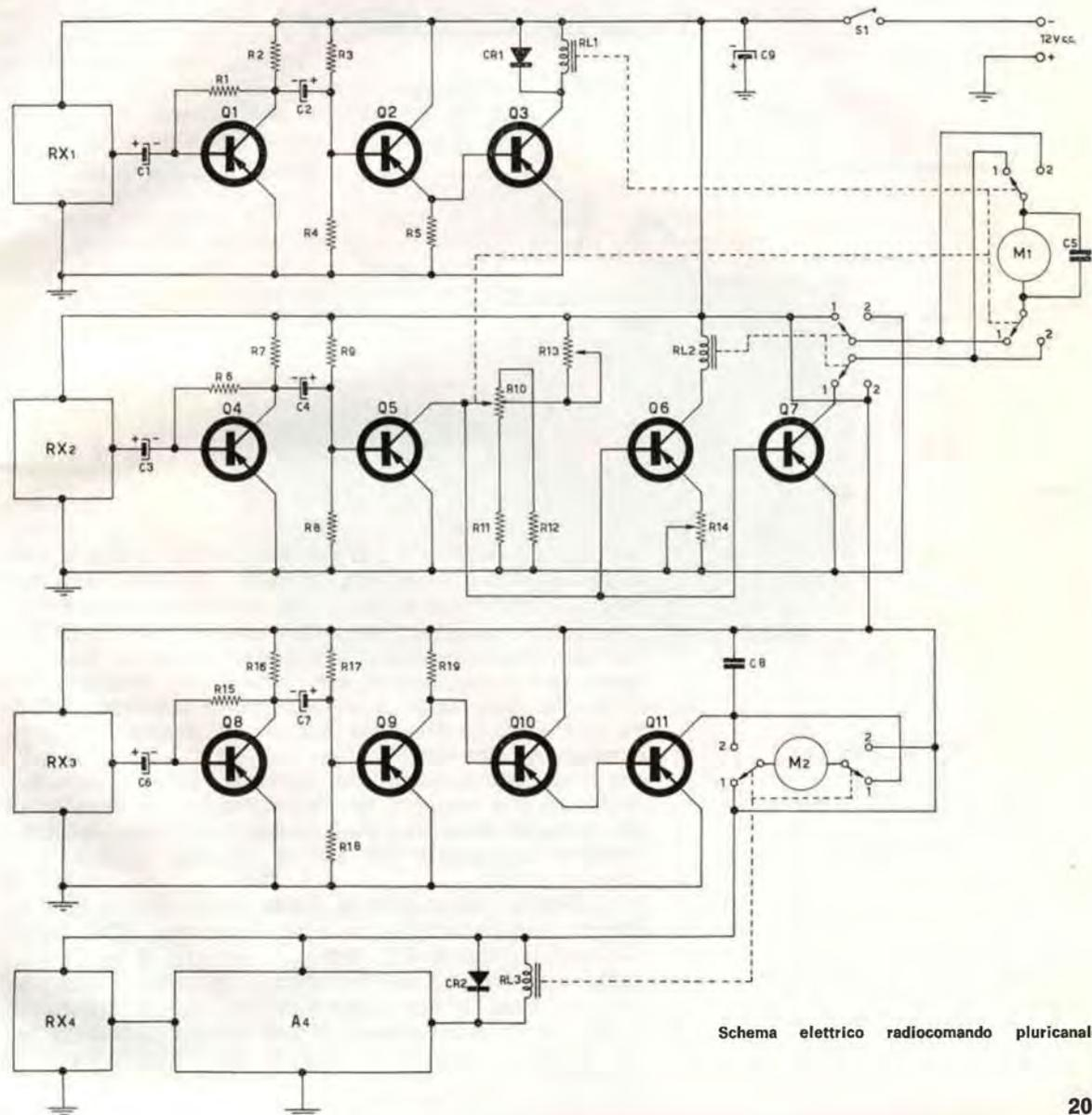
Schema elettrico radiocomando pluricanale
