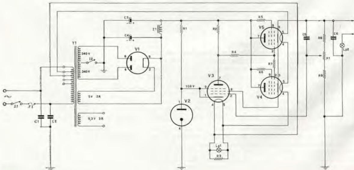
collegando all'alimentatore un circuito con una valvola, la tensione si abbassa a 350V, aumentando il numero delle valvole la tensione diminuirà ancora fino a scendere in taluni casi anche sotto i 200V e ciò evidentemente non è accettabile. I circuiti che seguono provvedono pertanto a stabilizzare la tensione su di un valore prescelto in modo che non si verifichino variazioni al variare del carico.
