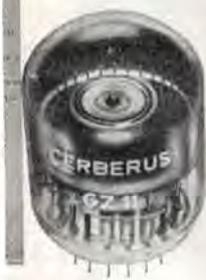
**Tubi numeratori** - Tubi con possibilità di azzeramento e di inversione del senso del conteggio.
