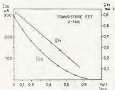
Figura 4 Misura di  $I_{DS}$  e  $g_{DS}$  in funzione di  $V_{GS}$
