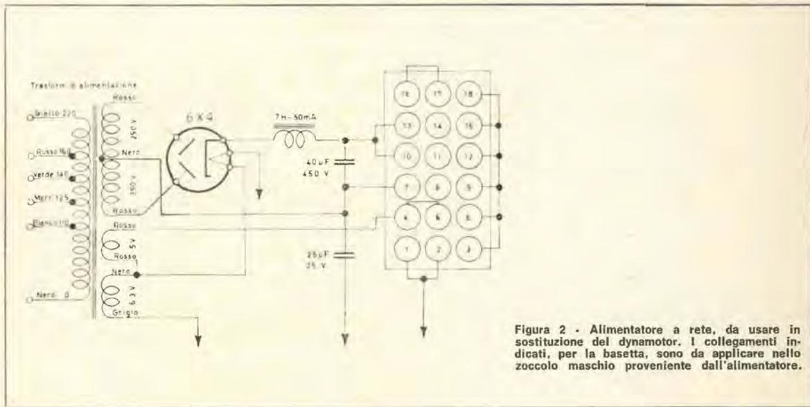
Figura 2 - Alimentatore a rete, da usare in sostituzione del dynamotor. I collegamenti indicati, per la basetta, sono da applicare nello zoccolo maschio proveniente dall'alimentatore.
