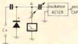
Mettendo il commutatore di funzioni su « capacimetro », l'indice va a fondo scala e si regola esattamente con lo zero-Cap; inserendo una Cx si verrà a ridurre l'impedenza tra il punto A e massa, e lo strumento retrocederà verso lo zero; la scala è tarata direttamente in pF, da zero a 2000.
