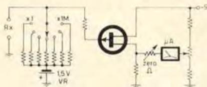
Come vedete, tramite Vr, che è una normale piletta da 1,5 volt, si riportano le misure di resistenza a misure di tensione ai capi della Rx. Effettuando una serie di misure con resistenze all'1% si sono trovati i seguenti valori:
