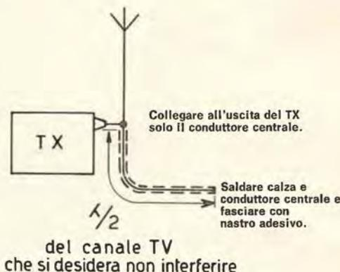
minuzione delle interferenze, ma non è finita qui infatti potremo ridurle ulteriormente collegando all'antenna del tx un marchingegno come da figura 2, la lunghezza del cavo in
