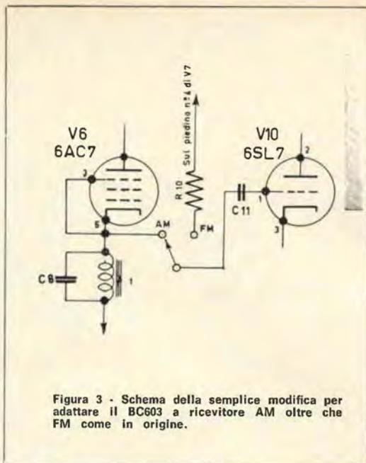
Figura 3 - Schema della semplice modifica per adattare il BC603 a ricevitore AM oltre che FM come in origine.
