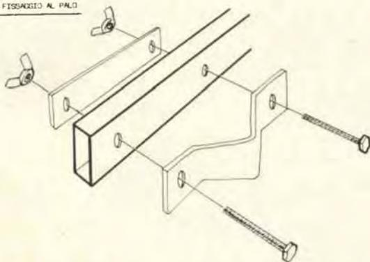
in tubo a sezione rettangolare di 10 x 15 mm. Gli elementi sono in filo  $\varnothing$  4 mm e il loro fissaggio è illustrato in figura 3.
