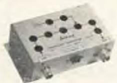
Relé coassiale realizzato con concetti professionali per impieghi specifici nel campo delle telecomunicazioni. Offre un contatto di scambio a RF fino a 500 Mhz con impedenza caratteristica di 50-75 ohm ed un rapporto di onde stazionarie molto basso. Potenza ammessa 1000 W. picco. Sono presenti lateralmente altri due contatti di scambio con portata 3 A 220 V. Consumi: a 6 volt, 400 MA  $\div$  a 12 volt, 200 MA  $\div$ . Costruzione: monoblocco ottone trattato, contatti argento puro.
