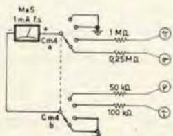
Particolari delle commutazioni per collegare strumenti di misura a punti importanti
