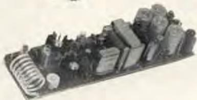
**Trasmittitore a transistori per la gamma dei 10 metri**
