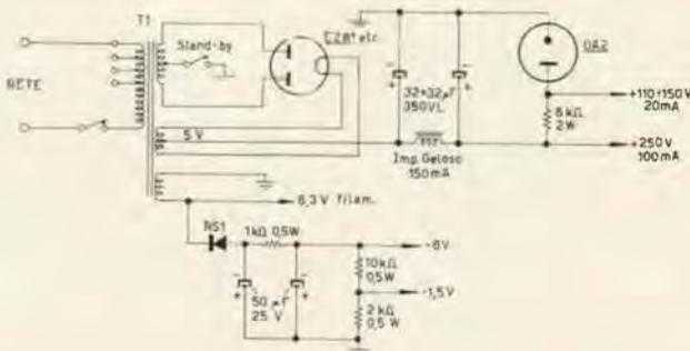
**T1 trasformatore 50-60W primario universale - secondario 250+250 V, 6.3 V - 3 A, 5 V - 2 A**
