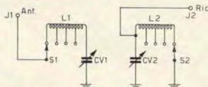
L'apparato, se così si può chiamarlo, è costituito da due circuiti accordati indipendenti ma accoppiati induttivamente fra di loro. Quello d'ingresso ha la sintonia in serie, infatti il variabile è collegato in serie alla bobina; mentre quello di uscita, cioè quello che va collegato al ricevitore, ha la sintonia in parallelo. Le due bobine sono affacciate l'una all'altra, alla distanza di circa un centimetro e mezzo.
