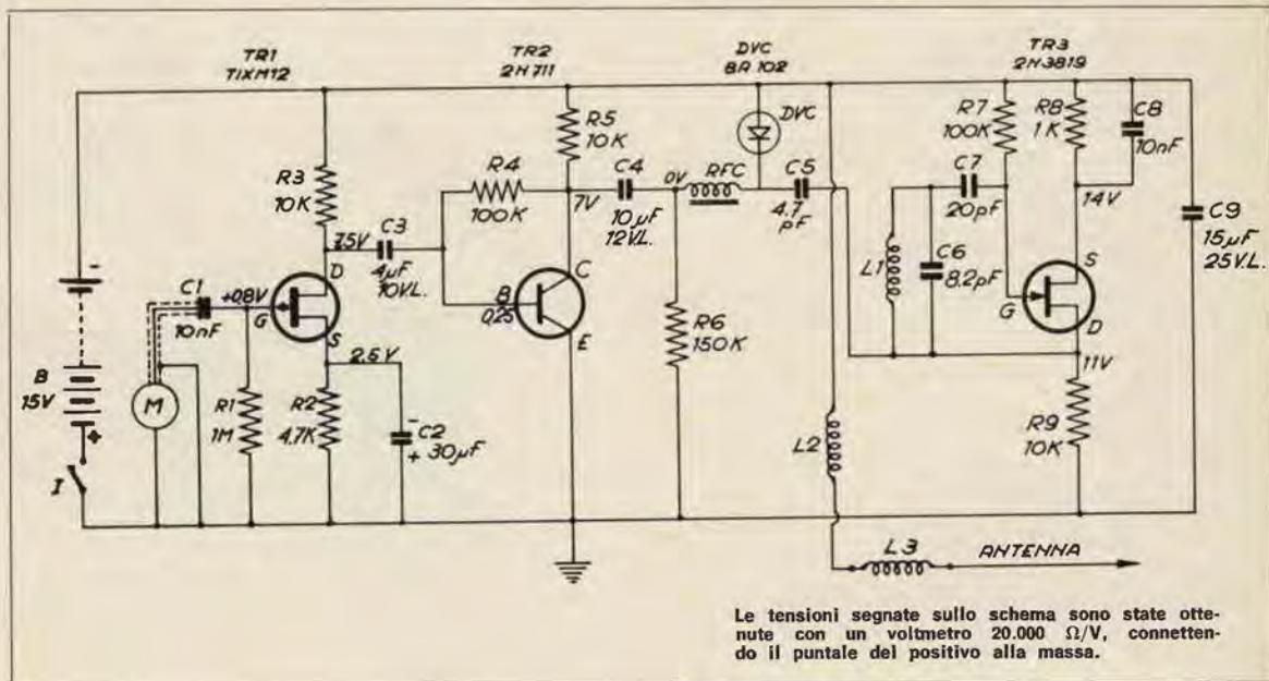
Le tensioni segnate sullo schema sono state ottenute con un voltmetro 20.000  $\Omega$ /V, connettendo il puntale del positivo alla massa.
