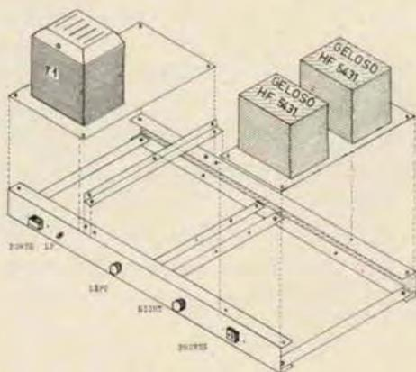
Vista esplosa delle principali parti meccaniche del telaio, costruito con profilato a U in alluminio di 2 x 4 x 2 cm, dello spessore di 2 mm. I trasformatori sono fissati su lastre di alluminio dello spessore di mm 2,5.
