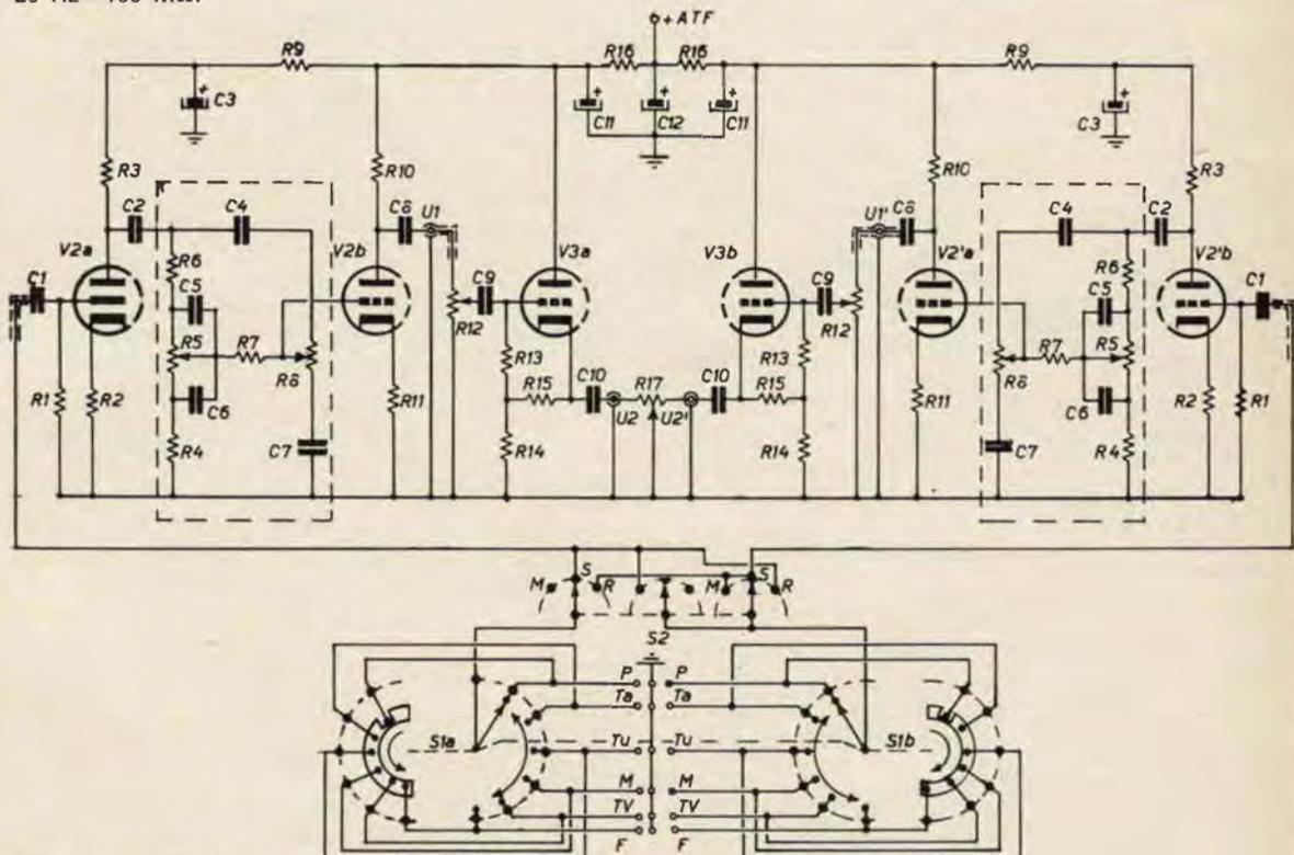
Avremo quindi che il segnale introdotto nel preamplificatore tramite C1 viene amplificato (da V2a) indi applicato alla sezione dei controlli di tono che nello schema di figura 6 appare in un riquadro tratteggiato, poiché questa parte non viene montata sul circuito stampato, ma i vari elementi vengono collegati ai terminali dei potenziometri, a loro volta collegati ai preamplificatori tramite cavetto schermato.
