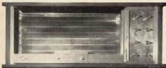
Si notano la rete di fondo, il telaio, il supporto per i potenziometri e i commutatori
