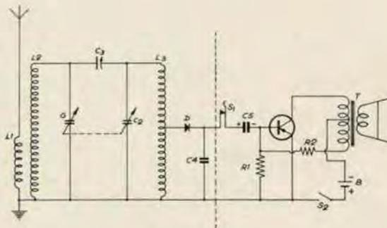
Quando il variabile C1C2, monocomandato, viene sintonizzato su una stazione, ad esempio del 1° programma, si aggiusta il compensatore C3 fino a ridurre al minimo l'interferenza del 1° programma o a farla addirittura sparire del tutto. Spostando quindi il variabile, quest'ultima stazione (del 2°) sarà udibile su altro punto della... scala.
