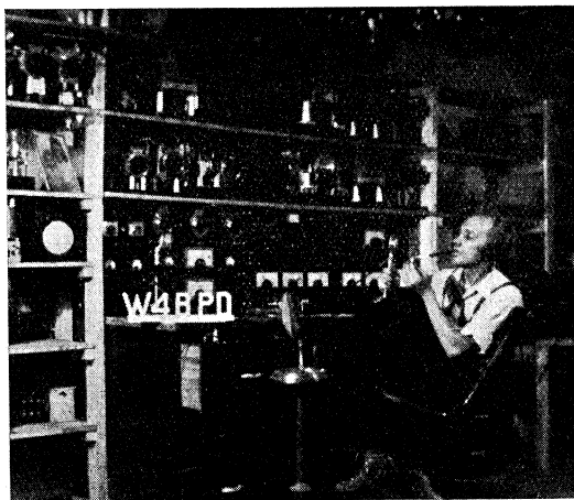
W4BPD, Gus aan de mike. Vlak voor hem 4 zenders elk van 1 kW. De reserve kW-rig staat links boven. Antenne schakelaars zijn boven het hoofd. Op de tafel, exciter en ontvangers
