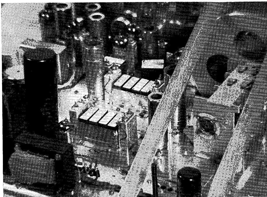
Bovenaanzicht. Links naast de afstemcondensator de VFO-buis en de tweede mengbuis. Daarnaast ziet u de beide 'back-to-back' filters. Meer op de achtergrond de MF-trappen en de carrier insertion oscillator. Zie ook de omslagfoto. (Foto: PAoLL)
