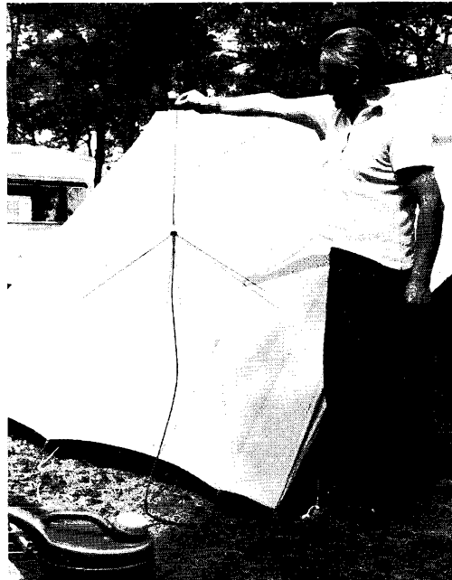
PAoYZ houdt de bougie-antenne hoog! In Electron van 1975 wordt op blz. 607 en 608 beschreven hoe PAoKRU deze groundplane antenne voor twee meter heeft gefabriceerd met een bougie als uitgangspunt. PAoNP maakte de foto op het VERON-Pinksterkamp 1976.
