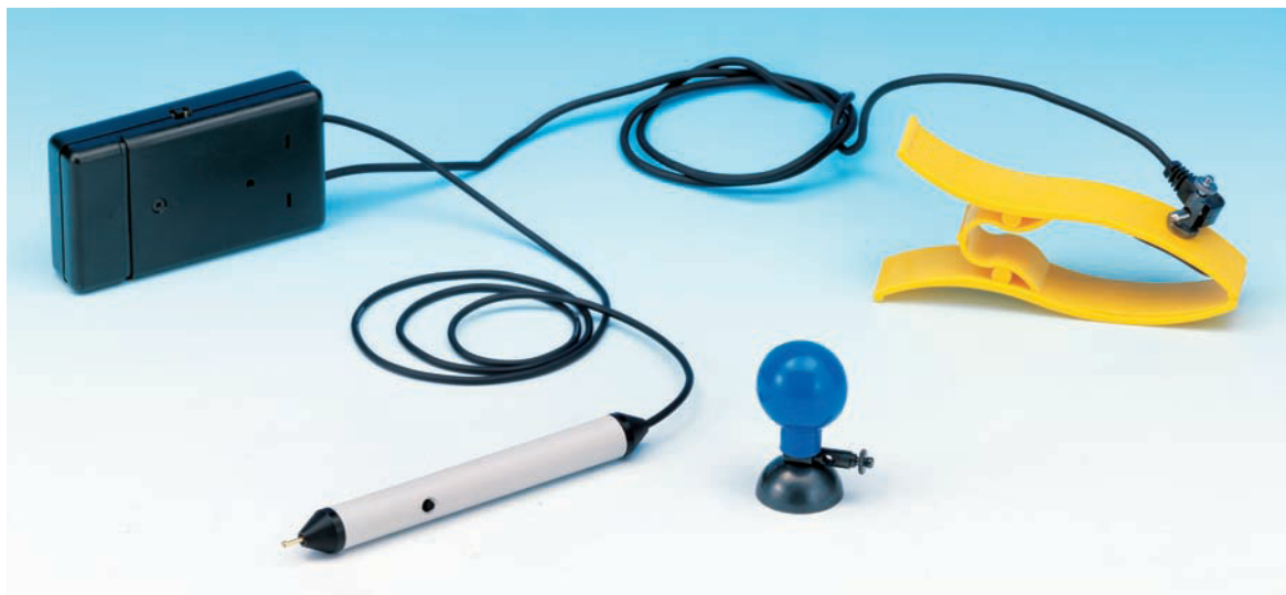
Figure 1 : Nous avons réalisé un véritable instrument professionnel se présentant sous la forme d'un petit boîtier plastique de poche qui contient le circuit et la pile d'alimentation. La pointe ergonomique permet la recherche des points d'acupuncture. Deux accessoires sont disponibles à part : la pince et la petite ventouse.
