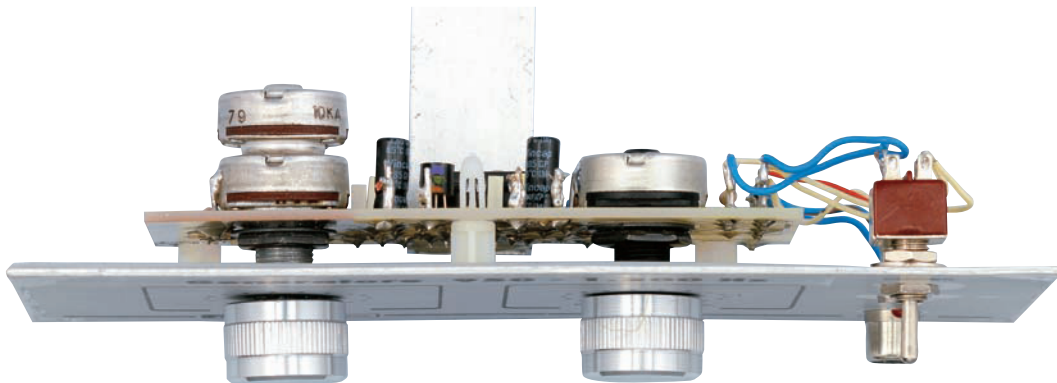
Figure 7 : Photo d'un des prototypes de la face avant sur laquelle on a fixé la platine. La face avant ainsi complétée peut ensuite être fixée sur le boîtier plastique à console (voir figure 8) avec des vis autotaraudeuses.
