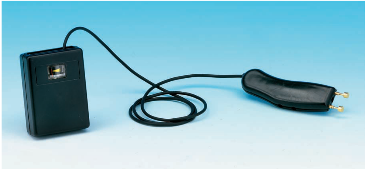
Figure 1 : Avec ce «skin detector» ou, mieux, cet impédancemètre dermatologique, il est possible de mesurer l'impédance de la peau en différents points du corps. La valeur de l'impédance obtenue peut fournir, à certaines conditions, une indication sur son état d'hydratation.
