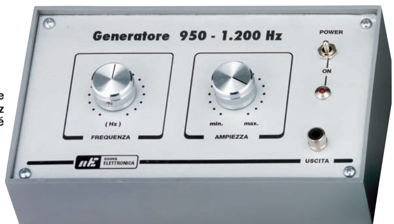
Figure 7 : Photo d'un des prototypes de la face avant sur laquelle on a fixé la platine. La face avant ainsi complétée peut ensuite être fixée sur le boîtier plastique à console (voir figure 8) avec des vis autotaraudeuses.
