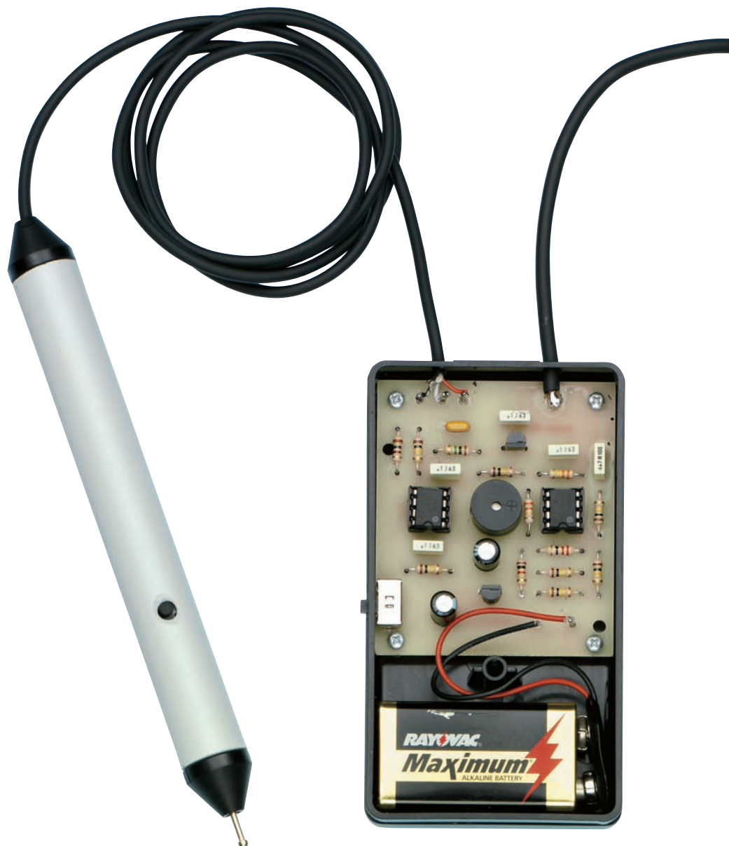
Figure 10 : Photo d'un des prototypes du chercheur électronique de points d'acupuncture EN1751. Sur l'arrière du boîtier plastique se trouvent deux trous : dans l'un on insère le câble blindé correspondant à la pointe, on soude soigneusement ses trois fils sur les pastilles du ci ; dans l'autre le câble de liaison correspondant au contact de masse, soit la petite ventouse soit la pince.
