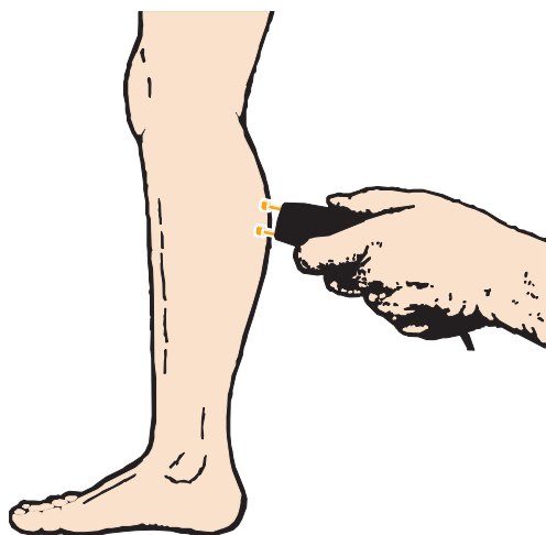
Figure 17 : Un autre point intéressant est la peau du mollet ou bien celle de la cuisse. Attention, quand vous effectuez la mesure : il faut éviter d'appuyer les contacts du détecteur sur les poils et les grains de beauté.
