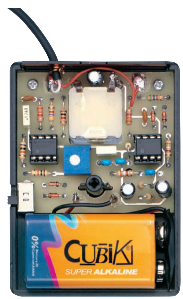
Figure 6 : Photo d'un des prototypes de la platine de l'impédancemètre dermatologique EN1748 logé dans son boîtier plastique. Au centre on voit la partie arrière microampèremètre et juste au dessous le trimmer utilisé pour le réglage du fond d'échelle. À droite, on peut voir l'intérieur du capteur de mesure de l'impédance de la peau.
