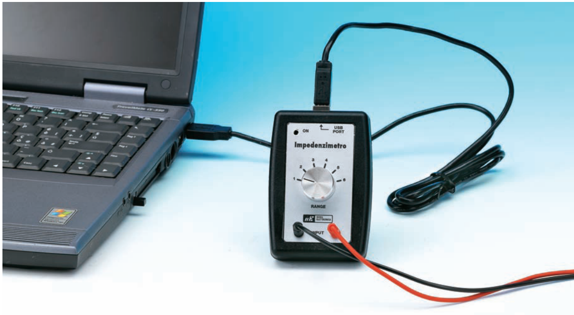
Fig.9 : Vous pouvez voir le commutateur S1 qui vous permettra de sélectionner les cinq calibres différents de l'impédancemètre. Pour éviter les erreurs de mesure, vérifiez que la position du commutateur coïncide toujours avec le calibre qu'indique le logiciel.
