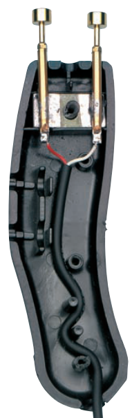
Figure 6 : Photo d'un des prototypes de la platine de l'impédancemètre dermatologique EN1748 logé dans son boîtier plastique. Au centre on voit la partie arrière microampèremètre et juste au dessous le trimmer utilisé pour le réglage du fond d'échelle. À droite, on peut voir l'intérieur du capteur de mesure de l'impédance de la peau.
