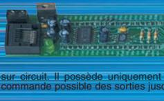
**Le Module M2** est un module comparable et implantable sur circuit. Il possède uniquement 2 entrées analogiques et une commande possible des sorties jusqu'à 1 amp.
