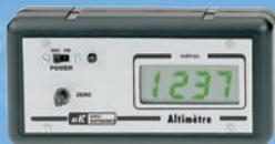
Avec ce kit vous pourrez mesurer la hauteur d'un immeuble, d'un pylône ou d'une montagne jusqu'à une hauteur maximale de 1999 mètres.
