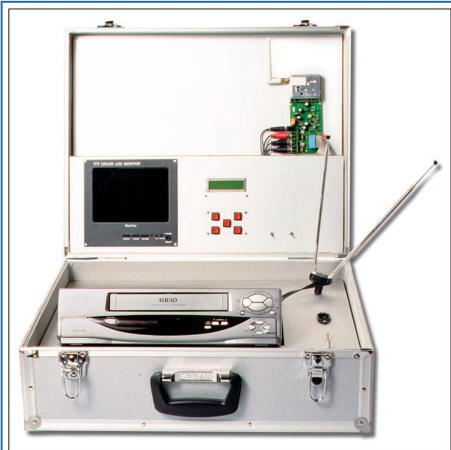
**Figure 1 : Notre mallette en aluminium abrite un récepteur audio-vidéo à 2,4 GHz, un récepteur TV pour les canaux H2 et 21, un écran plat, un magnétoscope, un bloc alimentation secteur, deux batteries et un convertisseur. Un équipement de ce genre, discret, léger et portable, sans en avoir l'air, pourrait constituer la parfaite panoplie de l'agent secret moderne !**
