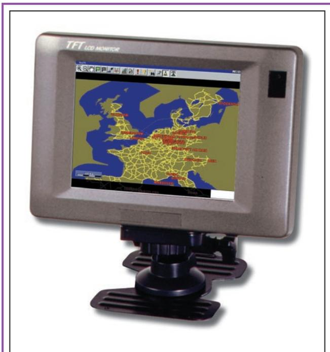
Figure 3 : Le moniteur utilisé pour notre PC de voiture est un écran LCD de 6,4" TFT avec entrée vidéo composite standard 1 Vpp/75 Ω. Il offre une résolution de 960 x 234 pixels et une entrée audio standard 0,5 à 1 V avec enceintes 1 W sous 8 Ω.
