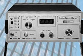
Cet appareil permet de connaître la valeur ohmique d'un dipôle à une certaine fréquence. Les applications sont nombreuses : impédance d'un haut-parleur, d'un transformateur audio, de l'entrée d'un amplificateur audio, d'un filtre "Cross-Over", de l'inductance parasite d'une résistance, la fréquence de résonance d'un haut-parleur, etc..
