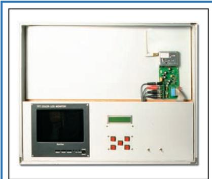
**Figure 9 :** La mallette doit avoir un couvercle suffisamment profond pour pouvoir y loger une petite plaque d'aluminium supportant l'écran et le récepteur. Le récepteur audio-vidéo peut alors être fixé sur le fond, protégé par les rabats.
