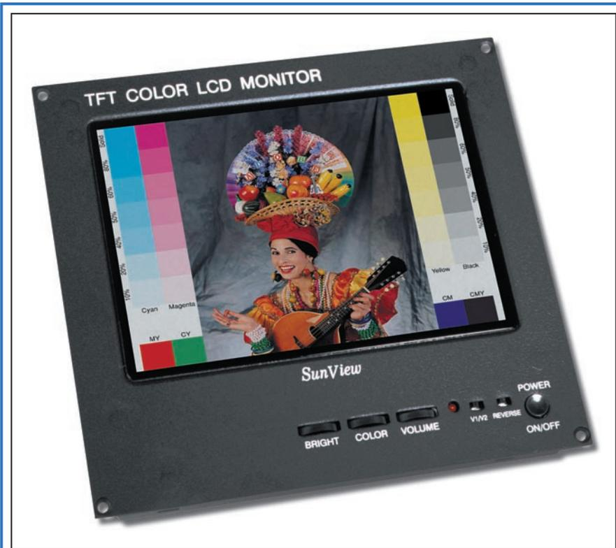
Figure 2 : L'écran utilisé est un modèle plat, à encastrer, de 5,6 pouces, fournissant images et sons, avec réglage de volume et interrupteur marche/arrêt.
