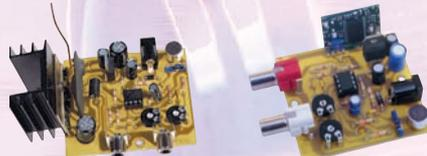
Emetteur audio/vidéo sur 479,5 MHz ou 224 MHz et dont le signal pourra être reçu par n'importe quel téléviseur, canal 22 UHF (ou 11 VHF selon version). Cette réalisation sera idéale pour surveiller à distance des lieux par l'intermédiaire d'une caméra vidéo et d'un micro.
