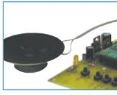
Cet appareil reconnaît un mot de passe prononcé par 4 usagers différents : les trois mots qui le composent sont préalablement mémorisés. La technique mise en œuvre est connue sous le nom de "Speaker Dependent" et le microcontrôleur est un RCS-300 de Sensory. Un relais permet la commande de la serrure ou de tout autre dispositif électrique.
