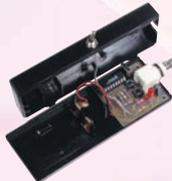
Ce générateur de mire a été étudié pour vérifier les moniteurs vidéo à entrées composites, les TV pourvues d'une prise PERITEL, mais aussi les câbles coaxiaux utilisés dans les installations de TV en circuit fermé. Un µC permet de produire une image avec un texte défilant et d'afficher l'heure.
