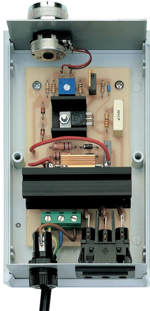
Figure 12: L'installation dans le boîtier plastique. La platine est fixée au fond du boîtier avec 4 vis autotaraudeuses.
