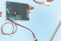
**TVCOM24**, en 20 ou 200 mW, sortie d'antenne SMA, sélection de fréquence via 3 roues codeuses.
