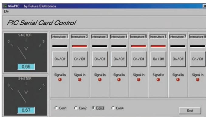
Figure 8a: Ecran visualisant le logiciel WinPIC, utilisé pour contrôler l'interface à relais. On remarque la sélection du port COM3. Bien que l'ordinateur dispose de deux ports sériels seulement, la COM3 est simulée par le pilote et le logiciel est en mesure de fonctionner sans aucun problème.
