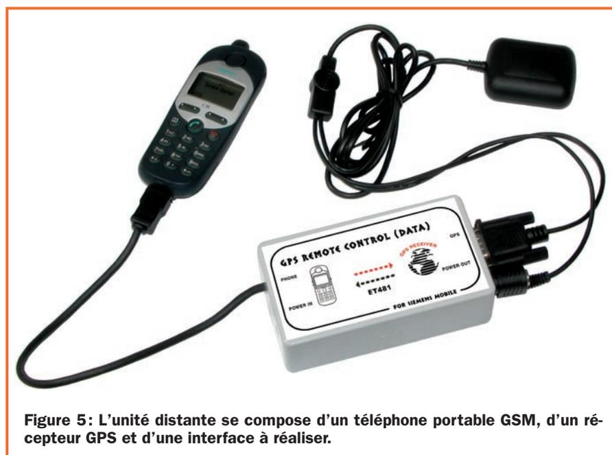
Figure 5 : L'unité distante se compose d'un téléphone portable GSM, d'un récepteur GPS et d'une interface à réaliser.
