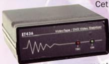
Cet appareil nettoie et régénère le signal de sortie des lecteurs de disques optiques (communément appelés "lecteurs de DVD"). Il permet un parfait visionnage de tous les disques audiovisuels. Bien entendu, il fonctionne de la même manière pour les magnétoscopes. Cet appareil ne doit être utilisé que dans le cadre de la loi.
