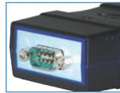
Le Tibbo DS100 est un serveur de périphériques sériels : il permet de relier tout dispositif doté d'un port sériel à un LAN\* Ethernet et, par conséquent, il autorise l'accès à tous les ordinateurs du réseau local ou à l'Internet sans devoir modifier le logiciel de pilotage. Il dispose d'une adresse IP et il peut communiquer à travers UDP et TCP. En outre, il supporte les protocoles ARP et ICMP.
