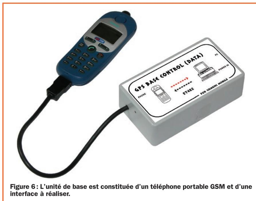
Figure 6 : L'unité de base est constituée d'un téléphone portable GSM et d'une interface à réaliser.
