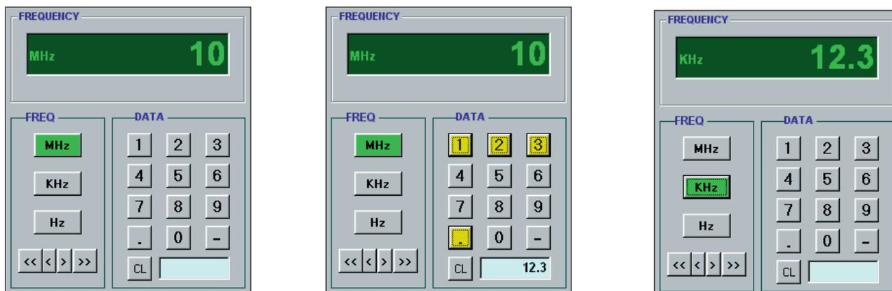
**Figure 14 :** Pour paramétrer une fréquence, inscrire d'abord sa valeur numérique (12.3) en utilisant les touches chiffrées du clavier DATA, puis insérez l'unité de mesure en MHz, kHz ou Hz en cliquant sur les touches du cadre Freq.
