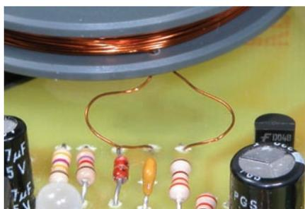
Figure 2b-2: Photo d'un des prototypes (détail : avant de souder les deux fils de la self, il faut gratter l'émail des extrémités et les étamer).
