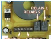
Ce lecteur de transpondeurs est caractérisé par son universalité d'emploi : il est en mesure de fonctionner comme système indépendant ("Stand Alone") ou relié à un ordinateur avec lequel il instaure une communication ("PC link"). Il est doté de deux relais pour gérer les dispositifs externes et d'un port sériel pour la liaison à l'ordinateur.
