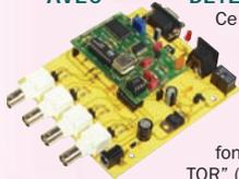
Ce système vidéo noir et blanc compact est capable de numériser quatre entrées vidéo et de les envoyer séquentiellement à un ordinateur au moyen d'une liaison série. Il dispose des fonctions QUAD et "MOTION DETECTOR" (détecteur de mouvement) numérisé avec réglage de la sensibilité.
