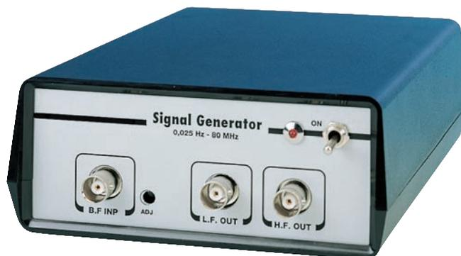
Figure 11: Le boîtier plastique du générateur BF-VHF vu de la face avant matérielle. La première BNC à gauche sert à l'entrée du signal BF de modulation AM externe. Le signal, modulé ou non, sort par les deux autres BNC LF Out et HF Out.
