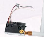
sortie: 10 mW sous 50 Ω. Entrée audio: 2 Vpp max. Alimentation: 12 Vcc. Livré sans antenne.
