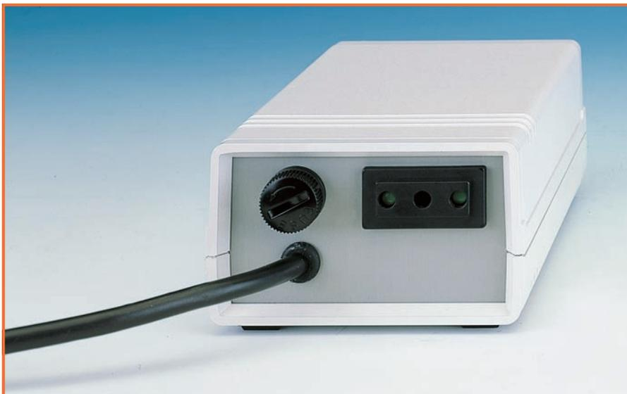
Figure 13: Le porte-fusible et la prise de sortie sont fixés sur le panneau arrière.
