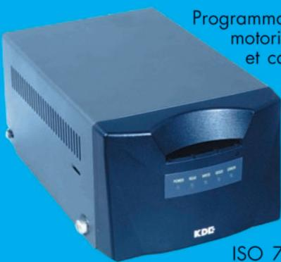
Programmeur et lecteur motorisé de cartes à puce et cartes magnétiques. Le système s'interface à un PC et il est en mesure de travailler aussi bien sur toutes les pistes disponibles sur une carte magnétique (standard utilisé ISO 7811) que sur des cartes à puce. Il est alimenté en 230 V et il est livré avec son logiciel.
