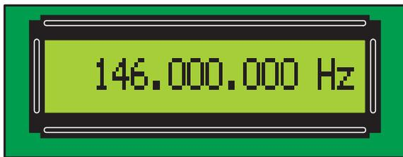
Figure 2: Si, à l'entrée A, nous appliquons une fréquence de 146 000 048 Hz, le prédiviseur la divise par 10, puis la base de temps de 0,1 seconde la divise par 10 et par conséquent sur l'afficheur LCD les deux chiffres de droite restent fixes à 00 et le nombre 146 000 000 est affiché.
