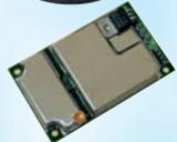
**GPS U2**, 12 canaux en parallèle avec SIRF II, antenne intégrée, batterie Lithium 3 V de sauvegarde, alimentation 4,75 à 5,25 Vcc / 160 mA, sortie RS232 jusqu'à 38400 Baud en protocole NEMA 0183 V2.0, entrée DGPS, épaisseur 2 cm seulement, diam. 5,9 cm, 150 g, câble de liaison de 3 m inclus!
