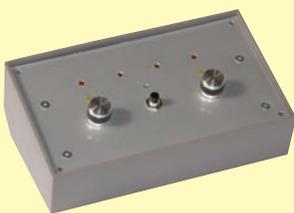
Quand il détecte un mouvement dans le signal filmé par une des quatre caméras vidéo, cet appareil fait passer automatiquement le moniteur du mode quad (écran divisé en quatre) au mode plein écran, afin de visualiser uniquement le signal intéressant. Il dispose, en outre, de deux relais de sortie à relier à une sirène d'alarme ou à n'importe quel autre dispositif auxiliaire d'avertissement. Le temps d'activation du relais est réglable par potentiomètre.
