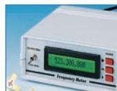
Dans le numéro 46 d'ELM nous vous avons proposé l'étude et la construction d'un fréquencesmètre numérique à afficheur LCD à 9 chiffres grimant jusqu'à 550 MHz et acceptant l'addition ou la soustraction de la MF d'un récepteur afin de pouvoir en afficher directement la fréquence. Dans cet article nous n'allons pas faire étalage des éloges que vous nous avez envoyés, mais nous allons plutôt répondre à vos critiques les plus intéressantes : envoi du dialogue!
