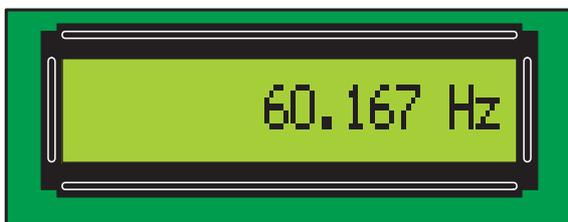
Figure 4: Si, à l'entrée B, nous appliquons des fréquences inférieures à 65 000 Hz, le microcontrôleur choisit automatiquement une base de temps de 1 seconde, la lecture est plus lente, mais nous avons l'avantage de voir s'afficher sur l'afficheur LCD les unités des Hz aussi.
