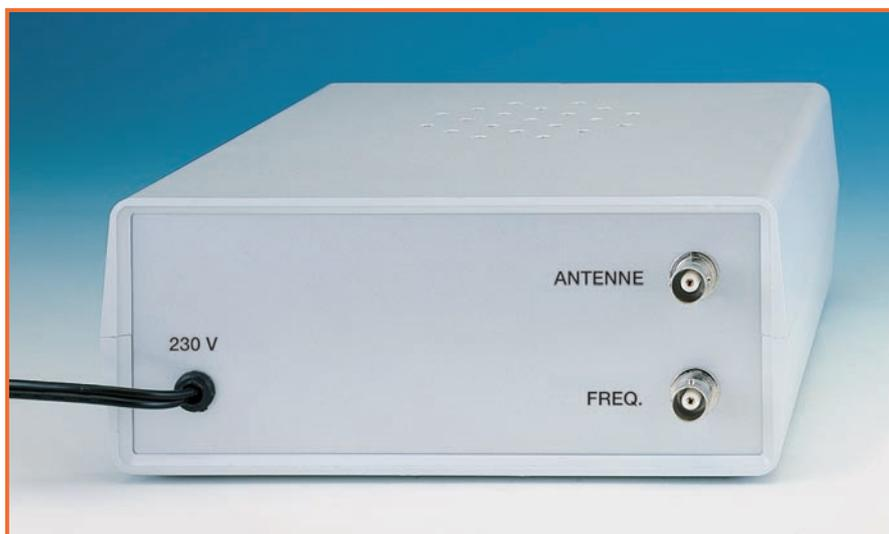
Figure 28: Le panneau arrière est percé de 3 trous. Par celui de gauche le cordon secteur 230 V entre à travers un passe-fils et ceux de droite permettent de monter les 2 BNC d'Entrée Antenne et de Sortie Fréquencemètre. Cette dernière permet de relier le récepteur au fréquencemètre numérique EN1525, afin de connaître avec exactitude la fréquence reçue.
