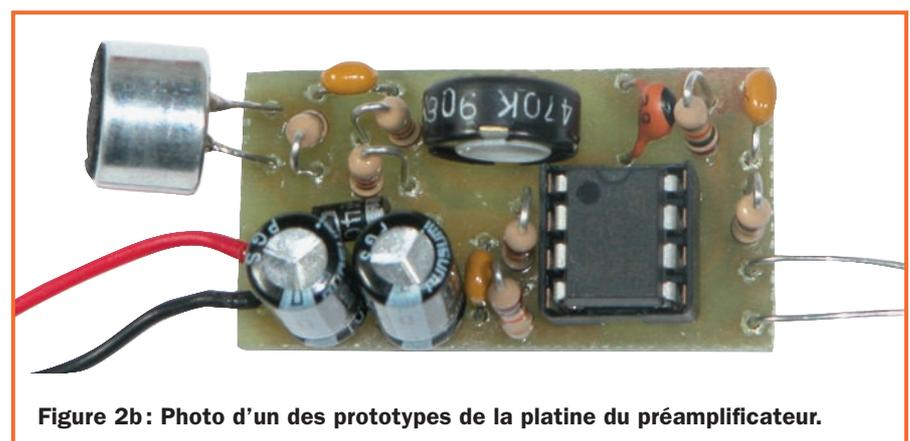
Figure 2b: Photo d'un des prototypes de la platine du préamplificateur.
