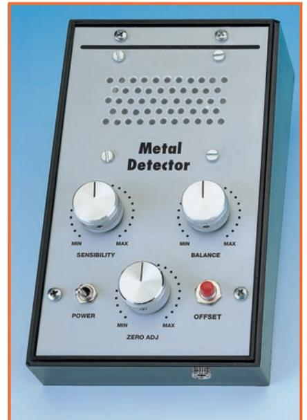
Figure 5: Vue de la face avant en aluminium du boîtier du détecteur de métaux à selfs équilibrées. Le premier bouton en haut à gauche sert à régler la sensibilité (R33, figure 9a), le deuxième à droite à régler l'équilibrage (R10) et le troisième en bas à régler la remise à zéro (R26). Si vous dosez parfaitement ces 3 boutons, vous pourrez découvrir des objets enterrés, même à de grandes profondeurs.
