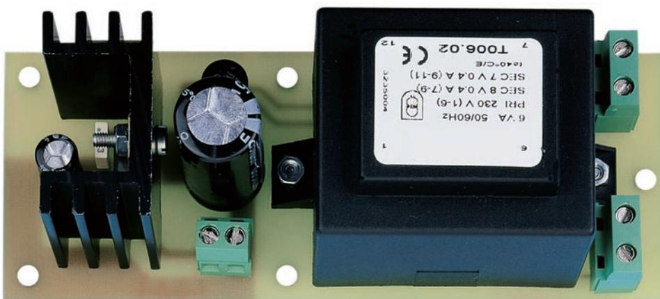
Figure 17: Photo d'un des prototypes de la platine alimentation fournissant le 12 V stabilisé à récepteur BLU. Attention à la polarité: le positif sort de la borne de gauche du bornier.
