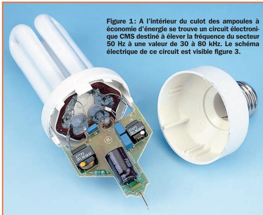
Figure 1: A l'intérieur du culot des ampoules à économie d'énergie se trouve un circuit électronique CMS destiné à élever la fréquence du secteur 50 Hz à une valeur de 30 à 80 kHz. Le schéma électrique de ce circuit est visible figure 3.
