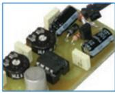
Cet appareil simple et d'usage universel permet de détecter les mouvements d'un véhicule ou d'un quelconque autre objet. Au moyen de deux trimmers, il est possible de régler la sensibilité du dispositif et le temps d'activation de la sortie du circuit après une détection.
