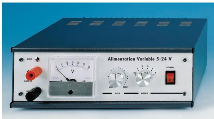
**Figure 1 : Photo d'un des prototypes de l'alimentation variable protégée en courant, installé dans son boîtier et prêt à fonctionner.**
