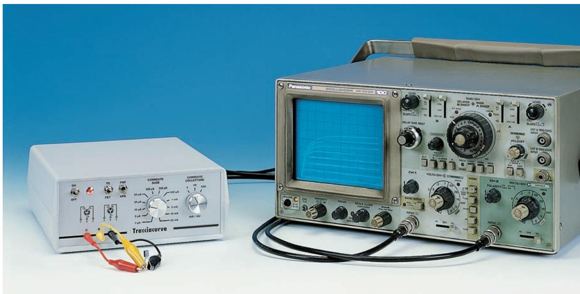
**P**assons en effet tout de suite à la réalisation pratique de la platine principale et de la platine de commutation, que nous installerons ensuite dans un boîtier plastique, puis nous réglerons ce traceur de courbe et commencerons à apprendre à nous en servir avec les transistors et les FET.
