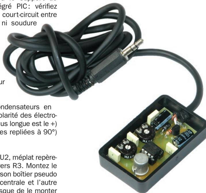
**Figure 5:** Montage dans le boîtier plastique de la platine du détecteur de mouvement. C'est un jack stéréo qui permet l'alimentation du module et la sortie du signal.
