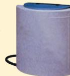
**ANTENNE PATCH DE BUREAU** avec support de table, gain 9 dB, connecteur N femelle, puissance maximale 100 Watts. Dimensions : 12 x 9 x 2 cm, polarisation H ou V, ouverture 60° x 60°, poids 1,1 kg.
