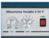
Si vous avez besoin d'une alimentation capable de fournir une tension stabilisée variable d'un minimum de 5 V à un maximum de 24 V 7 A, avec limiteur de courant réglable en plus, attentez-vous à ce montage : cette alimentation est dotée d'un limiteur de courant paramétrable aux valeurs de 500 mA, 1, 2, 3, 5 et 7 A. Dans cette première partie, nous allons d'abord voir la théorie. Dans la seconde partie, nous nous attaquerons à la réalisation.
