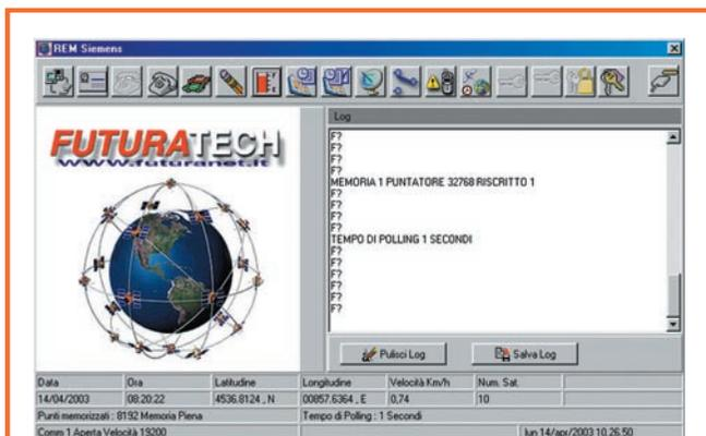
**Figure 7a : Ecran principal du programme. Dans la partie supérieure se trouvent 18 poussoirs permettant d'activer les diverses fonctions du logiciel. Dans la partie inférieure, certaines informations de localisation sont visualisées (date, horaire, latitude, longitude, vitesse du véhicule et nombre de satellites reçus).**
