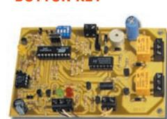
Cette serrure électronique de conception nouvelle est caractérisée par une très haute fiabilité de fonctionnement. Elle est pourvue d'un système anti-sabotage capable d'activer une sirène ou un autre signal d'alarme
