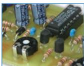
Ce circuit, composé de deux étages monostables, utilise les durées de charge des condensateurs pour retarder l'activation d'un relais par rapport à un événement générant une commande sur ses bornes d'entrée. Deux trimmers offrent la possibilité de paramétrer le temps de retard et la durée d'activation.
